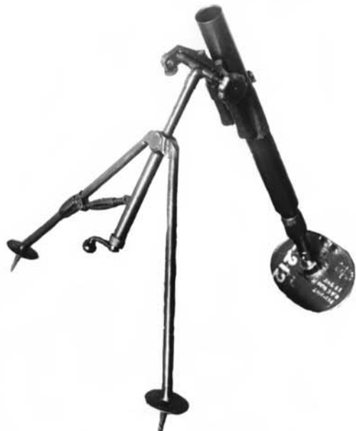
50-мм ротный миномёт образца 1938 г.
