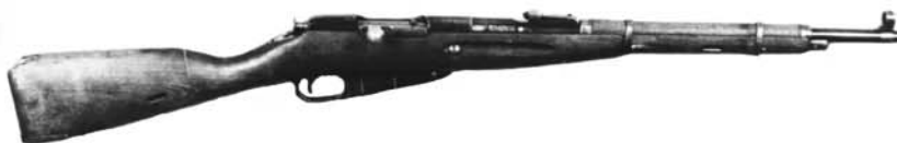
Магазинный 7,62 мм карабин образца 1938 г.
