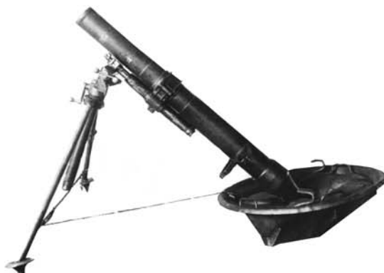
120-мм полковой миномёт образца 1938 г.
