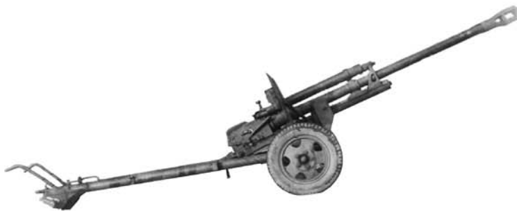
76-мм дивизионная пушка ЗИС-3 образца 1942 г.
