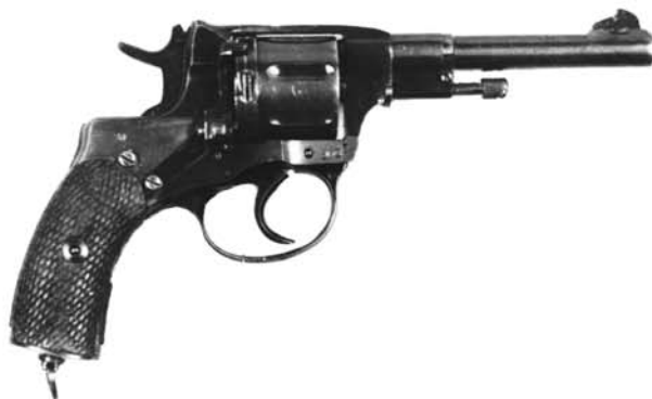
Револьвер 7,62 мм системы «Наган» образца 1895 г.
