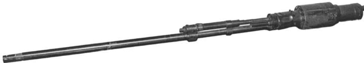
20-мм авиационная пушка системы Шпитального-Владимирова ШВАК образца 1936 г.
