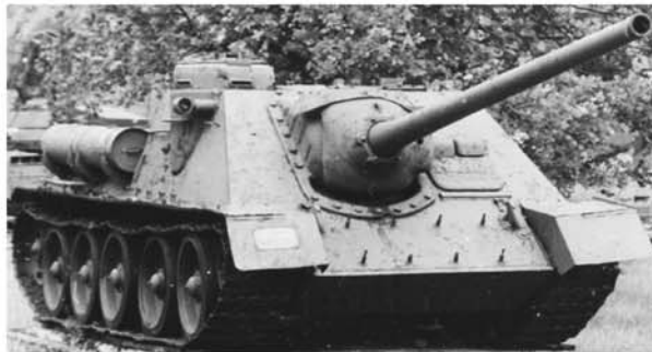
100-мм самоходная установка СУ-100.
