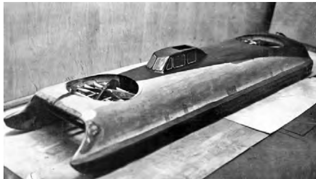
Макет катера на воздушной подушке Л-1
