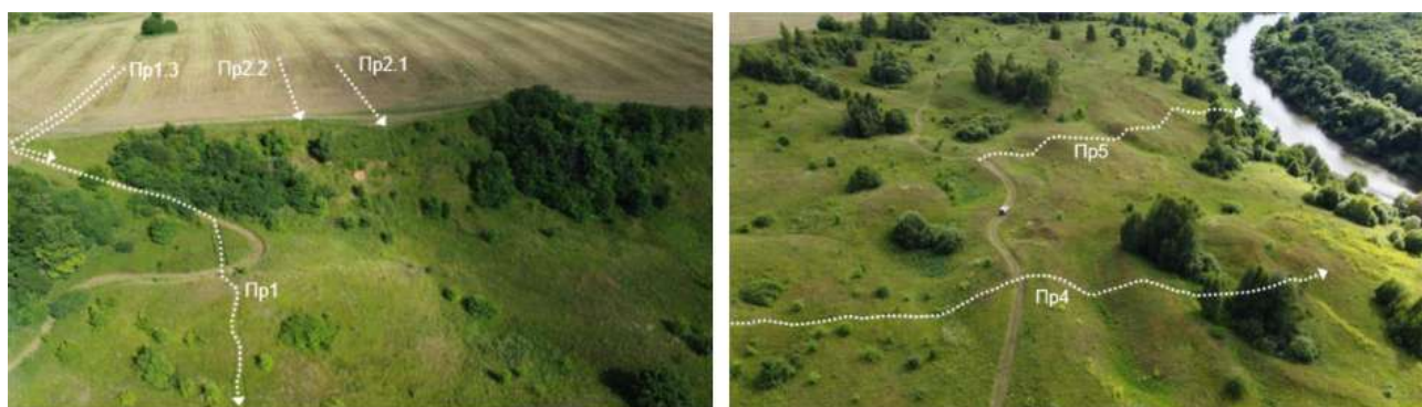
Рис. 3. Схема размещения георадарных профилей вблизи деревни Никитино.
