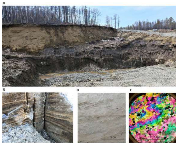
Рис. 1. Вскрытая карьером залежь пластовых льдов в 2 км от п. Верхний Бестях. Приленское плато: а – общий вид исследованного участка карьера; б – горизонтальные прослои крупного песка в пластовом льду; в – текстура льда с пузырьками, ориентированными перпендикулярно слоистости; г – кристаллическая структура льда в поляризованном свете.
