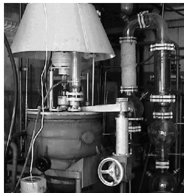
Фрагмент технологической линии экстракции из растительного сырья субстанций, используемых в производстве моющих средств.
