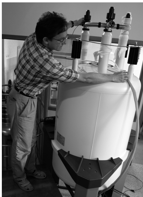
Идет наладка нового спектрометра ЯМР.
