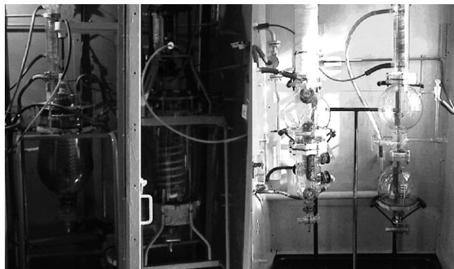
Фрагмент технологической линии синтеза субстанции противоракового лекарственного препарата “Глицифон”.
