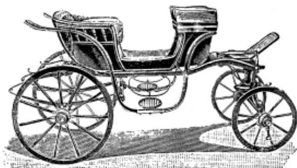
№ 30 а). ТЕЛѢЖКА На подпатентованныхъ осяхъ, лакированной кожи крылья, обивка шагреевая, съ 2-ми фартухами однокошная 175—200 р. парокошная 190—225 р.
