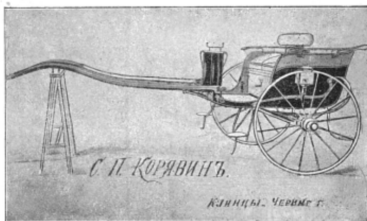
№ 33 ШАРАБАНЪ. Вѣсъ отъ 10 пуд. 2-хъ колесный, шорный, на латентованныхъ осяхъ съ фона- рями, 4-хъ мѣстной—отъ 200 до 250 руб.
