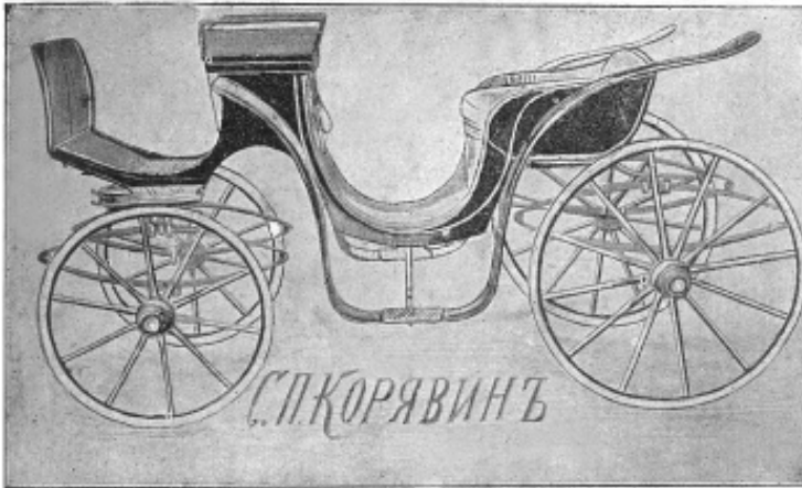
№ 10. ПРОЛЕТКА. Въѣсъ 15—17 п. На патентованныхъ осяхъ, на резиновыхъ шинахъ, съ лакиро- ванными крыльями, 2-ми фартухами лаковой кожи, цѣна: одноконной 450 р.—500 р. пароконной 500 р.—575 р.
