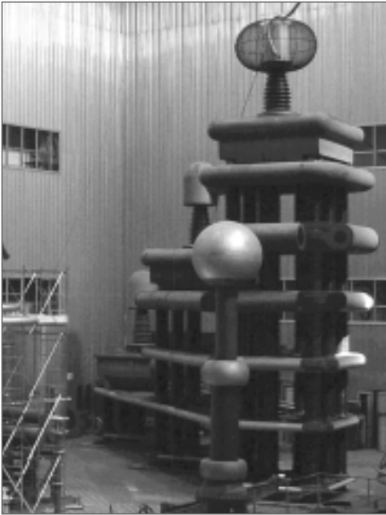
Установка каскадная испытательных трансформаторов ИОМК 3x750/2250
