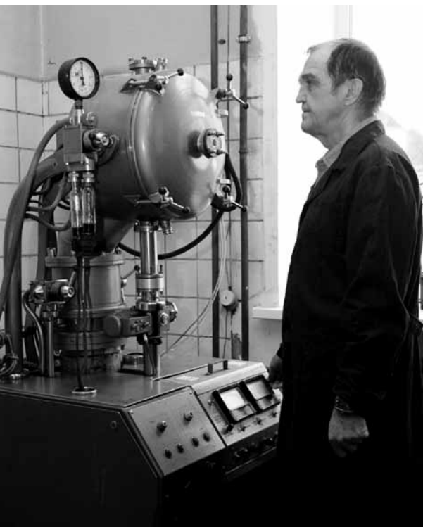
Установка для выращивания монокристаллов методами Бриджмена и Чохральского (за пультом установки С. Букин)
