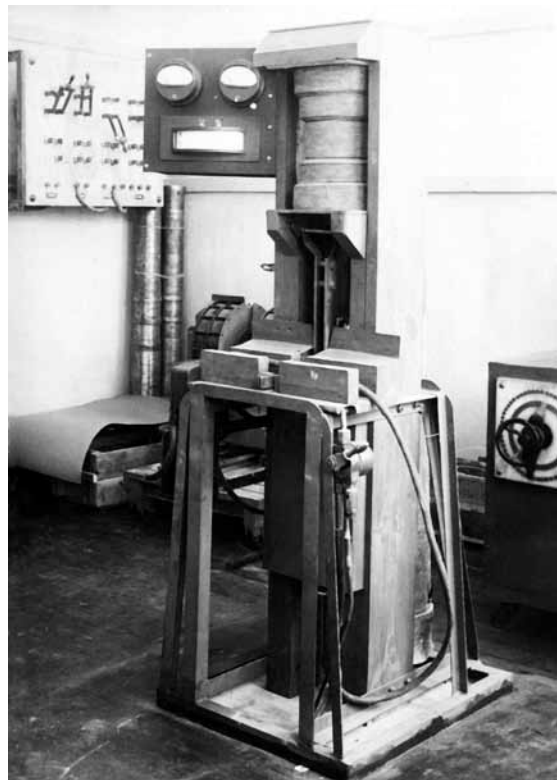
Аппарат для контроля корпусов артиллерийских снарядов, 1943 г.
