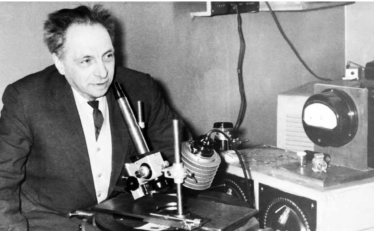
Я.С. Шур за прибором для наблюдения вида доменной структуры ферромагнетиков
