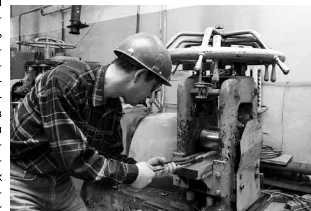
Кузнечное оборудование отдела прецизионной металлургии: вверху – пневматический молот (кузнец Л. Бажуков); внизу – прокатный стан (кузнец А. Бизяев).
