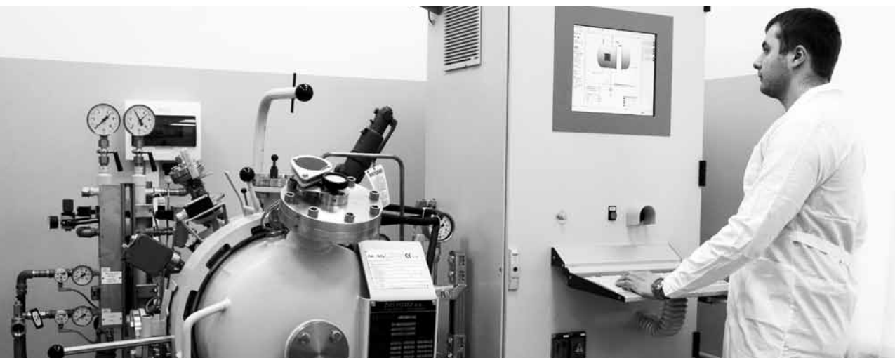
Индукционная печь PVA TERLA, позволяет проводить плавку в вакууме и в защитной атмосфере (за пультом – научный сотрудник Д. Давыдов)
