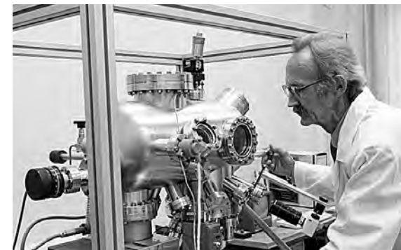
Исследования на сверхвысоковакуумном сканирующем туннельном микроскопе VT STM (Omicron Nanotechnology) ведёт Л.Н. Ромашев.
