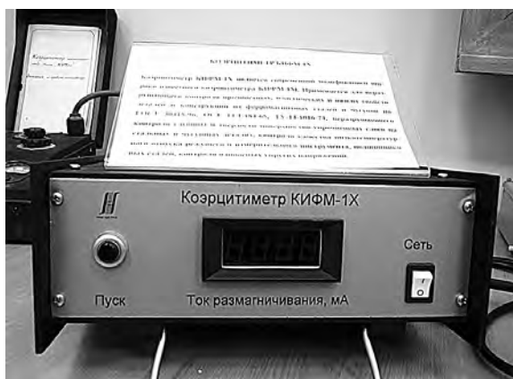
Коэрцитиметр КИФМ-1X, является модификацией коэрцитиметра КИФМ-1
