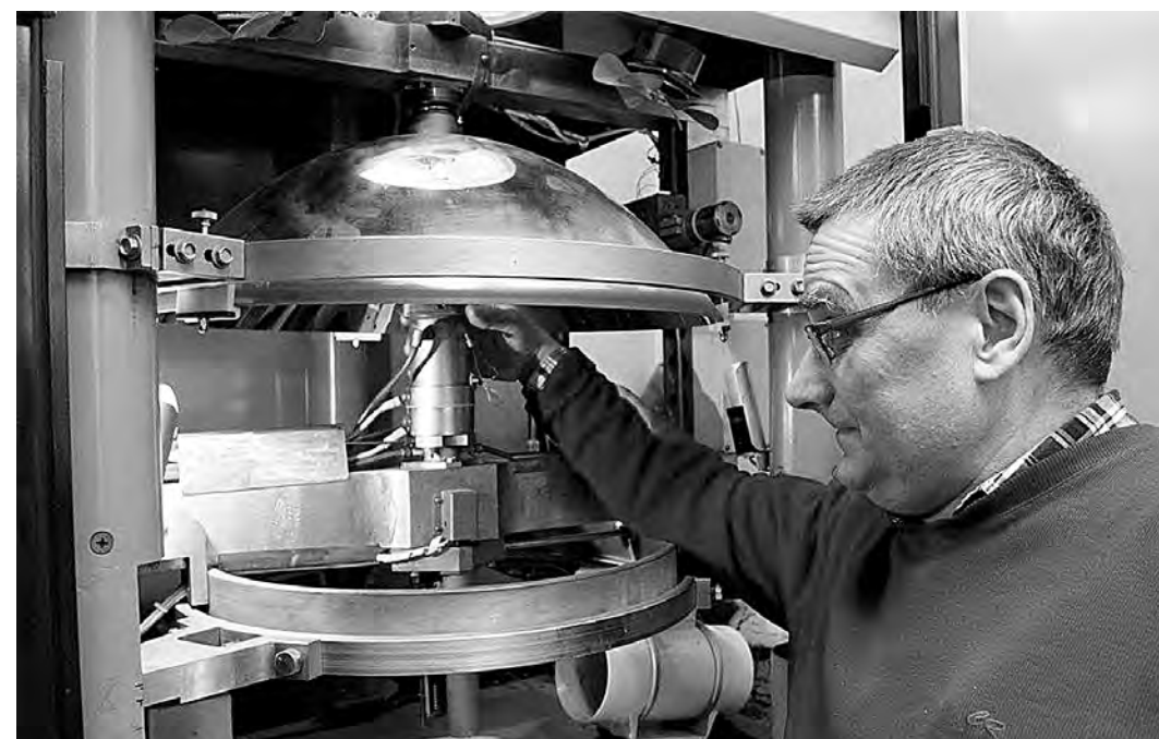
С.В. Наумов в процессе работы с установкой радиационной зонной плавки.
