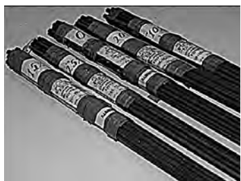
Стандартные образцы, соответствующие 0, 10, 15, 20 и 25% износу канатов
