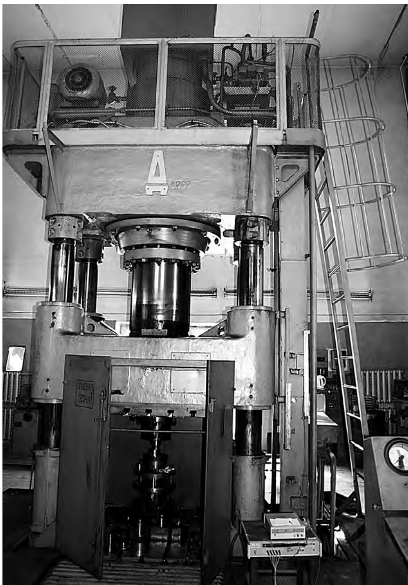
Гидравлический пресс усилием 10000 кН
