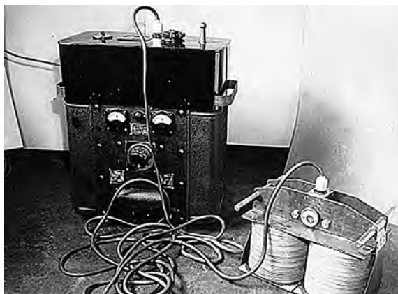
Первая модель коэрцитиметра. Внедрён в 1938 г. на Первоуральском Новотрубном заводе
