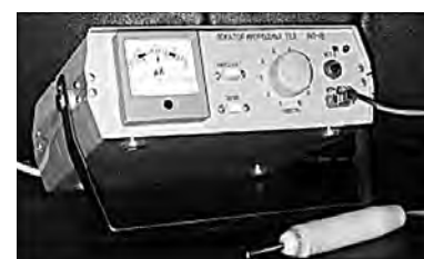
Вихретоковый локатор инородных металлических тел ЛИМТ-2. Зависимость выходного сигнала датчика от формы инородных неферромагнитных тел: 1 – шар; 2 – диск; 3 – пластина; 4 – стержень
