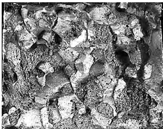
Камневидный излом стали 38НМФА-Ш (А.Б. Кутьин)
