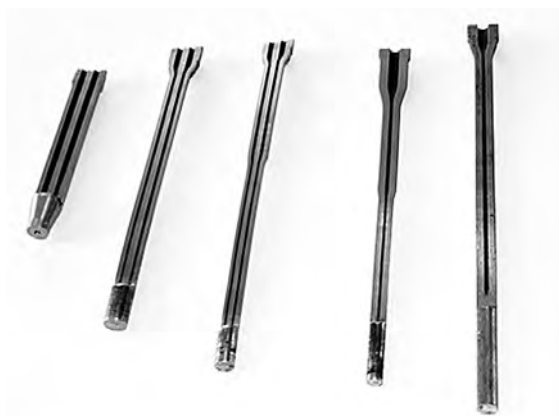
Фотография образцов с длинными отверстиями малого диаметра, изготовленных гидроэкструзией на «гидравлической оправке».
