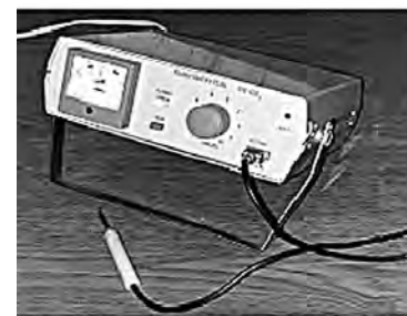
Феррозондовый полюсоискатель. Зависимость показаний прибора от ориентации датчика (а, б) к инородному ферромагнитному телу при горизонтальном перемещении датчика: 1 – под углом 30°; 2 – под углом 60°; r=20 мм
