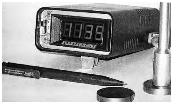
ИМПАС-1 – прибор для определения магнитной проницаемости парамагнитных сплавов и сталей
