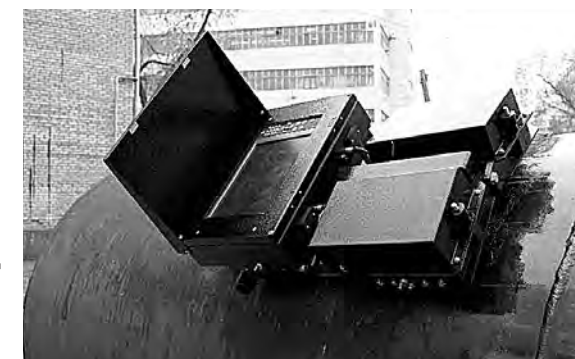
Ультразвуковой бесконтактный сканер-дефектоскоп «Автокон-ЭМА-МГТУ».
