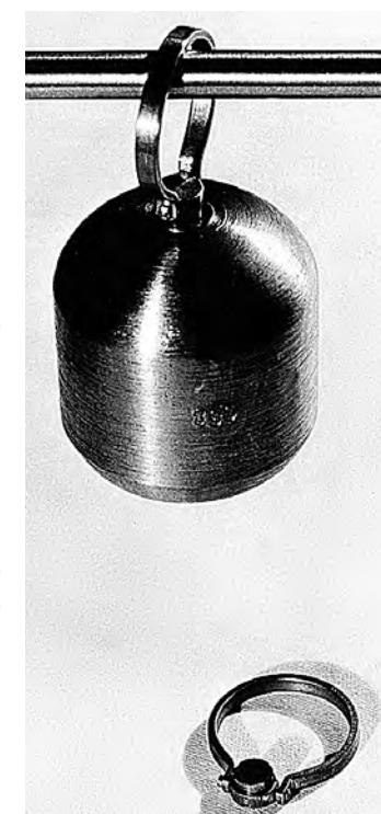
«Таблетка» магнита из сплава \text{SmCo}_5 в 1,5 г удерживает гиру весом 1 кг.
