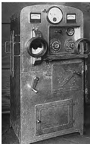
Первый дифференциальный магнитный прибор для контроля качества подшипниковых колец (1959 г.)
