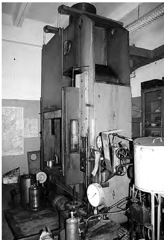
Гидравлический пресс усилием 4000 кН
