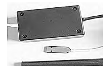
Аппаратура для контроля перемещения внутритрубных дефектоскопов
