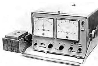
Дифференциальный магнитный структуроскоп ДМС-2
