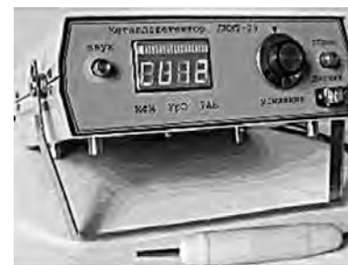
Вихретоковый локатор инородных металлических тел ЛИМТ-2Э. Зависимость выходного сигнала датчика от формы инородных неферромагнитных тел: 1 – шар; 2 – диск; 3 – пластина; 4 – стержень
