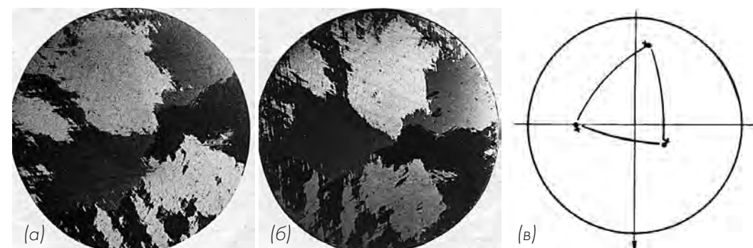
Восстановление макроструктуры (а, б) и кристаллографической ориентировки (в) закалённого бикристалла стали 37ХН3Т (В.М. Счастливцев): а – исходное состояние, х 4; б – после повторного медленного нагрева до 950 °С с последующей закалкой, х 4; в – кристаллографическая ориентировка аустенита (1 – исходное состояние, 2 – после повторного нагрева до 950 °С и последующей закалки)
