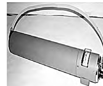
Аппаратура для контроля перемещения внутритрубных дефектоскопов
