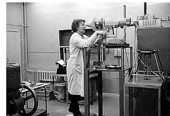
Н.К. Архипова, измеряет температуру в высокотемпературной вакуумной печи с помощью пирометра
