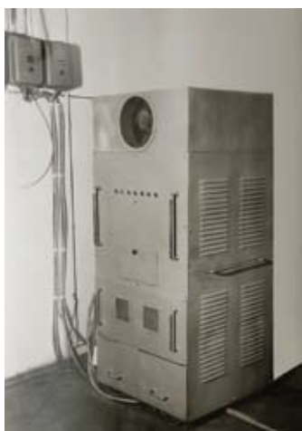
Универсальная цифровая вычислительная машина (ЦВМ) последовательного действия с оперативной памятью из 2016 слов длиной по 32 бита (машина ГИФТИ)
