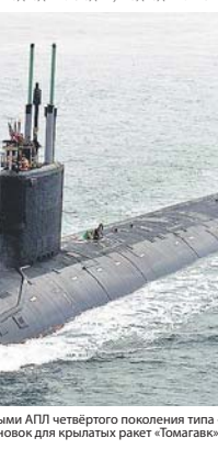
ВМС США располагают 19 многоцелевыми АПЛ четвёртого поколения типа «Вирджиния», каждая из которых имеет 12 вертикальных пусковых установок для крылатых ракет «Томагавк». На снимке — головная лодка проекта USS Virginia (SSN-774).
