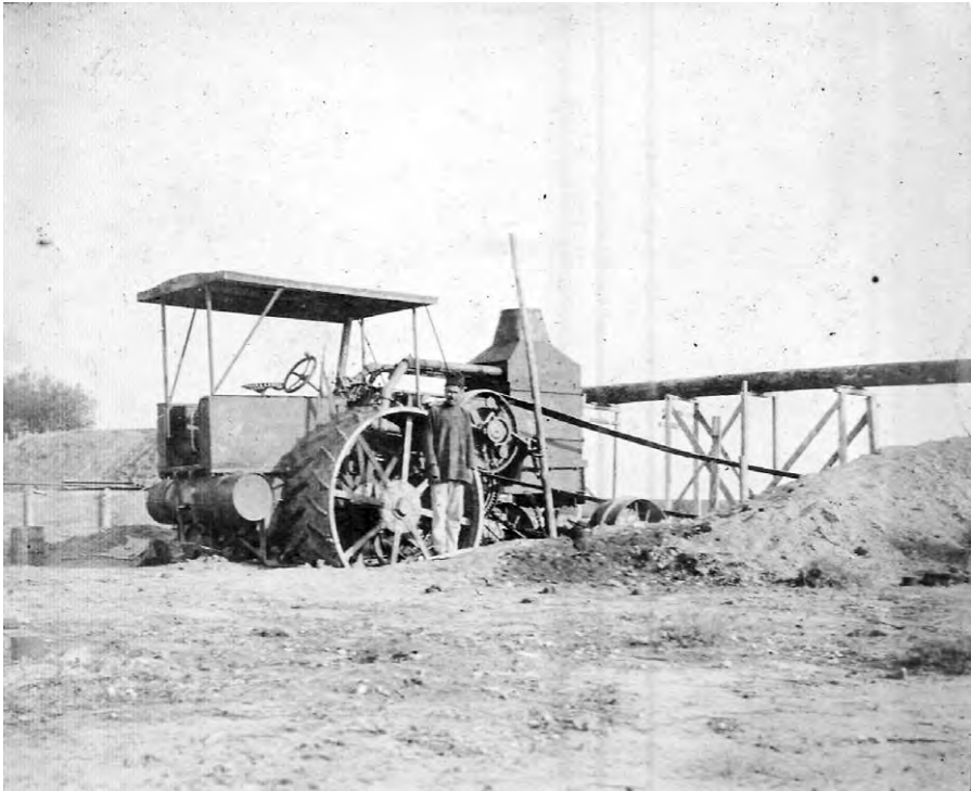
Трактор-тягач иностранного производства на паровом двигателе в имении Полибино. На фото находится в неработающем состоянии. На переднем плане виден ремень, накидываемый на шкив, который приводил в действие какой-либо другой механизм (молотилку, насос и пр.). Фото 1906 г. Автор неизвестен. Из архива Л.Б. Щегловой.
