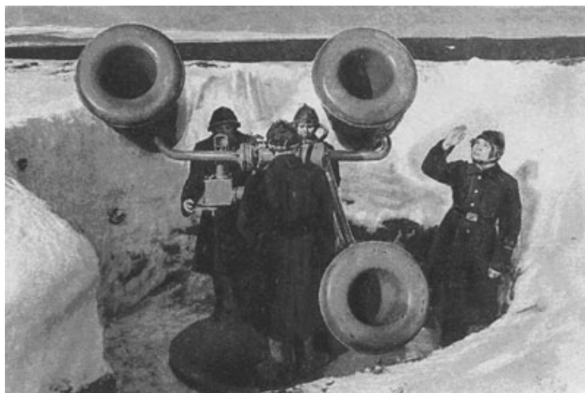
Пост звукового контроля службы ВНОС, размещенный около главной базы Северного флота в Полярном
