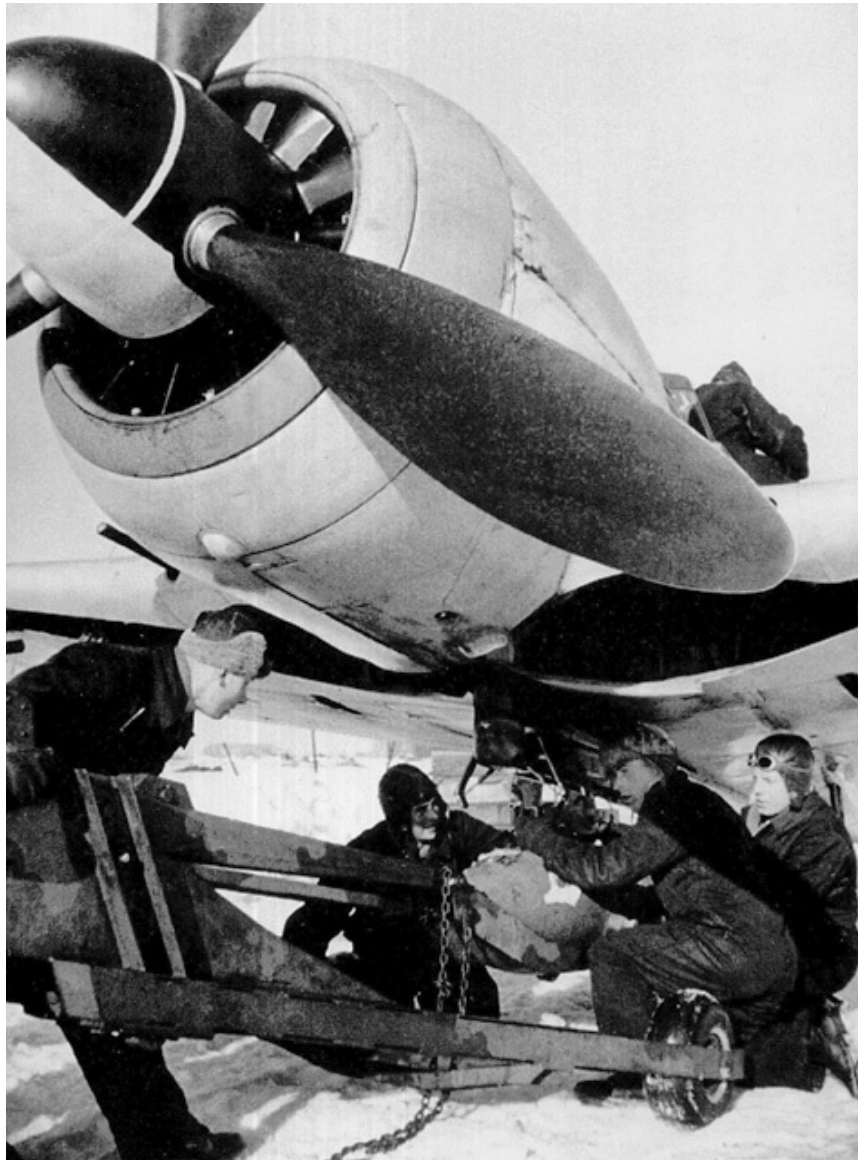
Техники подвешивают бомбу под фюзеляж FW-190А-3 из 14.(Jabo)/JG5
