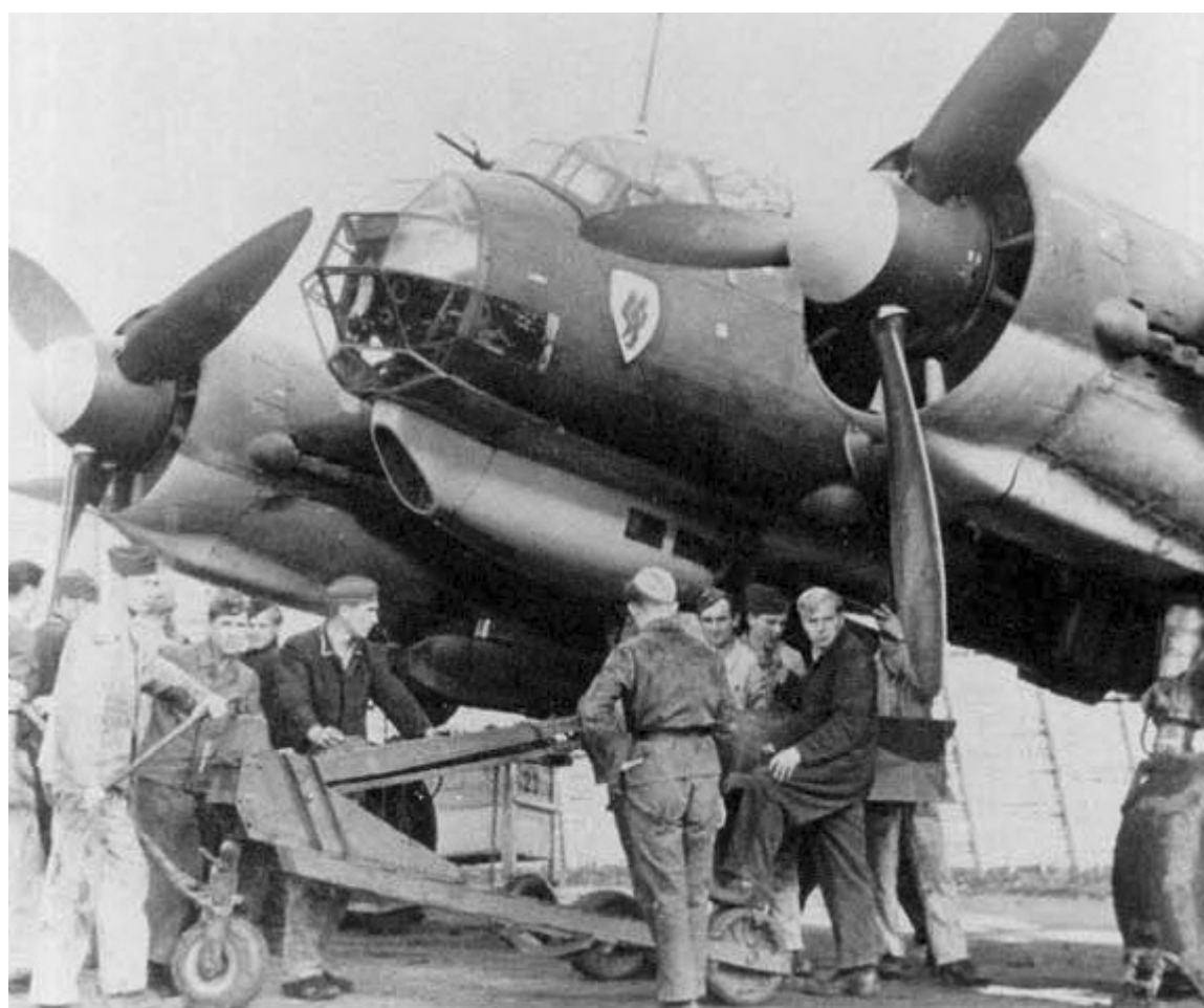
Техники подвешивают бомбы под центроплан Ju-88A-4 из I./KG30
