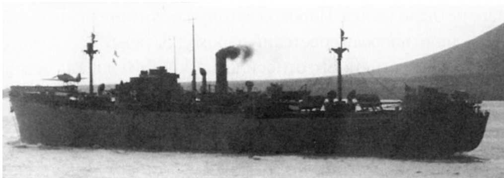
Британский транспорт «Эмпайр Лоуренс», в его носовой части видна рампа с установленным истребителем «Си Харрикейн»
