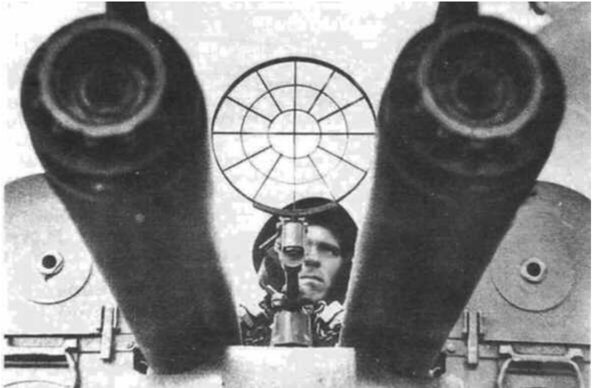
Спаренный 12,7-мм пулемет «Кольт-Браунинг», установленный на эсминце «Гремящий»
