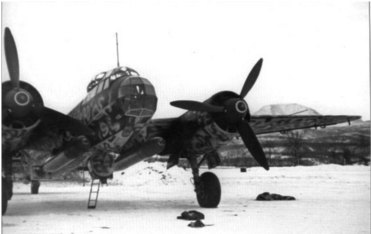
Ju-88A-17 из 3-й эскадрильи KG26 с двумя подвешенными торпедами F5, аэродром Бардуфос, 9 февраля 1945 г.
