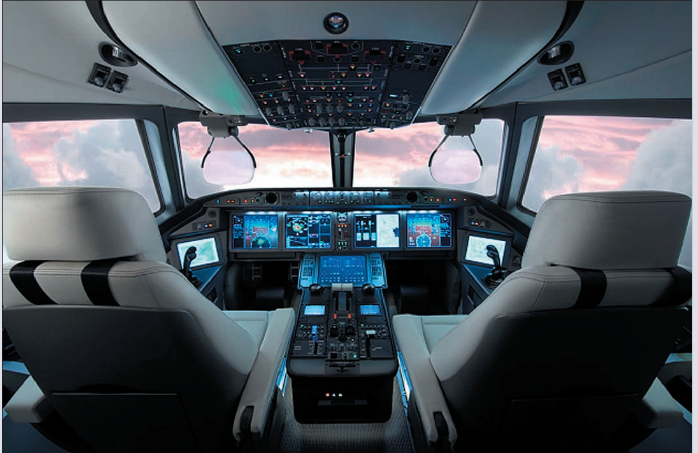
Макет кабины ближнесреднемагистрального пассажирского самолёта МС-21 (магистральный самолёт XXI века) с оборудованием УКБП
