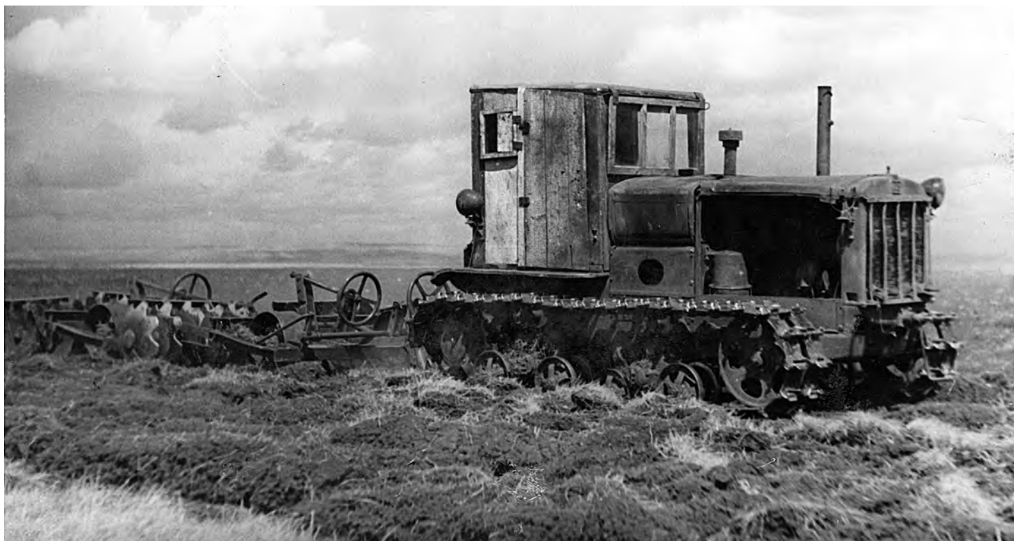
Трактор СХТЗ-НАТИ на полях Тисульского района. 1939 // Из фондов историко-краеведческого музея Тисульского района. На фото хорошо видно, что кабина трактора сделана кустарным способом из деревянных досок
