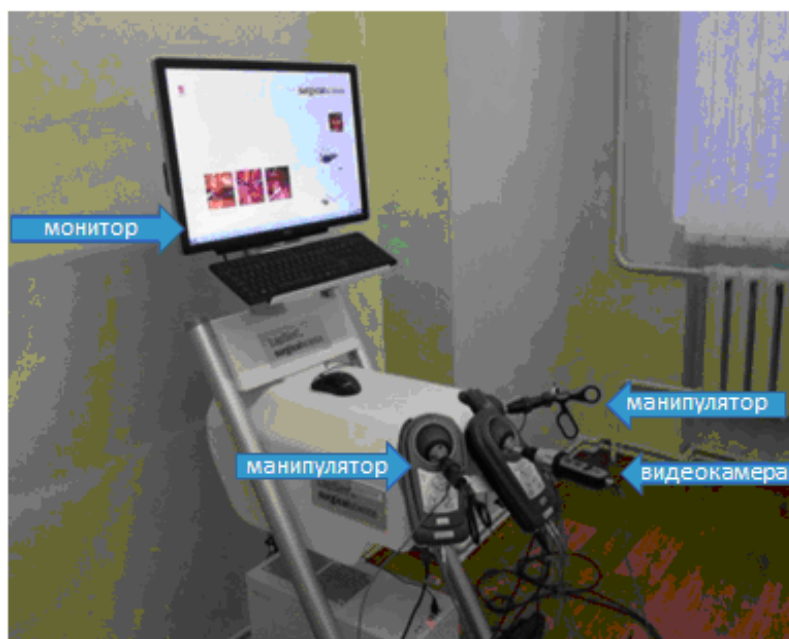
Рисунок 3. – Виртуальный симулятор ЛапСим
