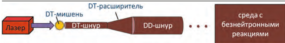
Рисунок 6. Схематичное изображение процесса термоядерной детонации
