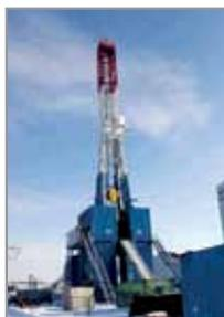
В Калининграде на заводе по производству строительных металлоконструкций ООО «ЛУКОЙЛ-Калининградморнефть» (100% дочернее предприятие ОАО «ЛУКОЙЛ») состоялась презентация буровой установки «ЕРМАК». Установка оснащена уникальной гидравлической системой передвижения, при помощи которой может пошагово передвигаться во всех направлениях и вокруг своей оси на 360 градусов. Установка может использоваться как для эксплуатационного, так и для разведочного бурения;
