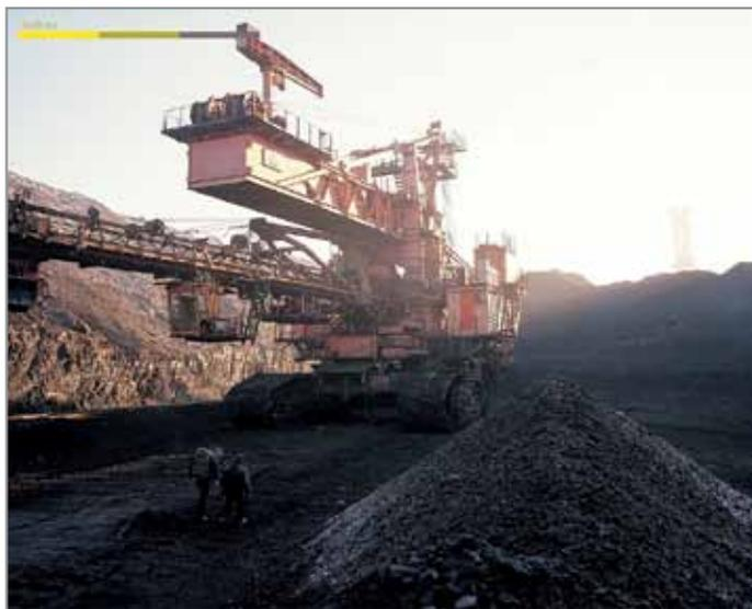
высокой технологической организации работы экскаватора и снижению непроизводительных простоев. Погрузка самосвалов осуществлялась по прогрессивной технологии на два подъезда, что позволило довести суточную производительность экскаватора до 48,5 тыс. куб. м вскрыши в сутки.
