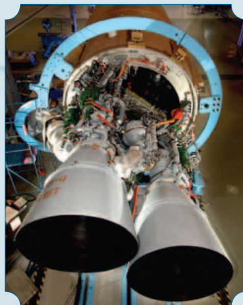
Рулевые приводы на РД180 при монтаже на I ступени ракеты-носителя «Атлас-5»
