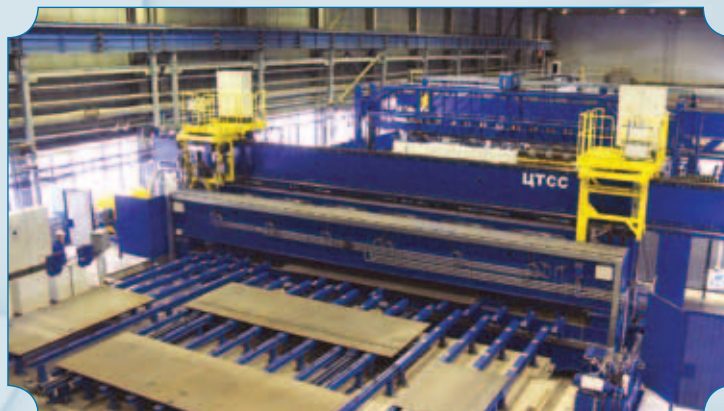
Технологическая линия для изготовления плоских секций с применением лазерных технологий
