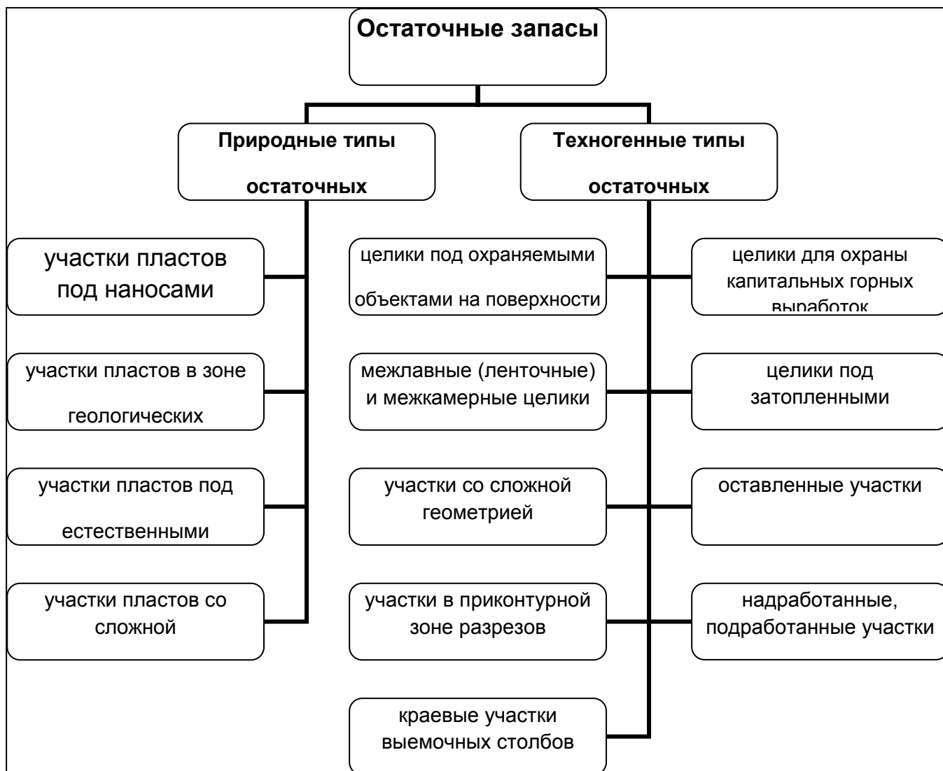
Рис. 1 – Типы участков пластов с остаточными запасами угля.
