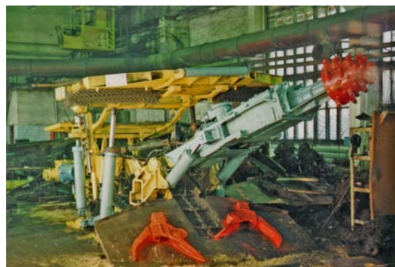
Рис.2. Проходческий комплекс КПЧ-10. (заводские испытания). Патент РФ №2184846 с механизмом передвижения –К.
