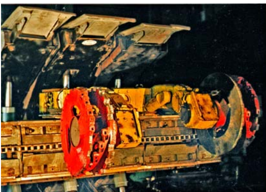
Рис.1. Проходческо-очистной механизированный (блок) ПОБЧ-2. (в стадии изготовления). Патент РФ №217240 с механизмом передвижения – РСС.
