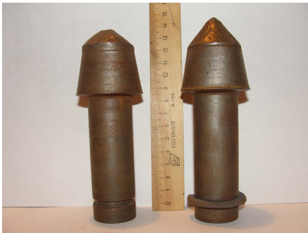
Рис.4 . Резцы РГПМ после 1 цикла эксплуатации на комбайне КСП-35
