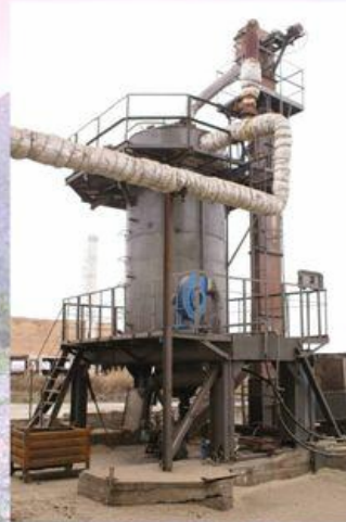
Газификатор «Сибтермо» на зерносушилке ООО «Балахтинский хлеб» отработал три сезона
