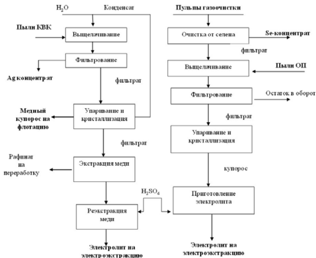
Рис. 1. Принципиальная технологическая схема переработки тонких пылей и газоходных пульп медного производства ОАО «Кольская ГМК».
