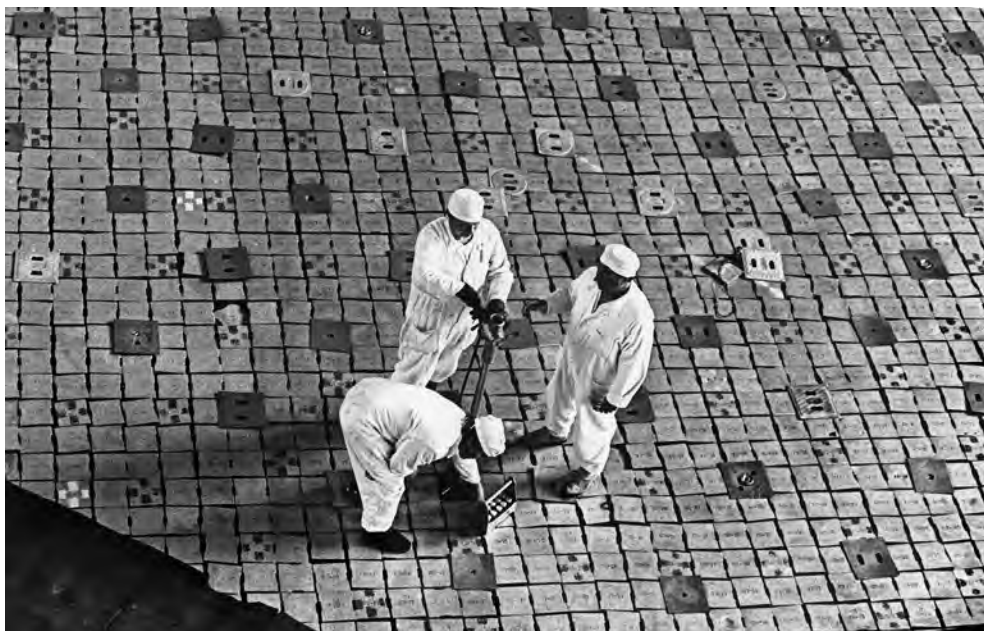
Операция загрузки канала на реакторе «АВ-2»
