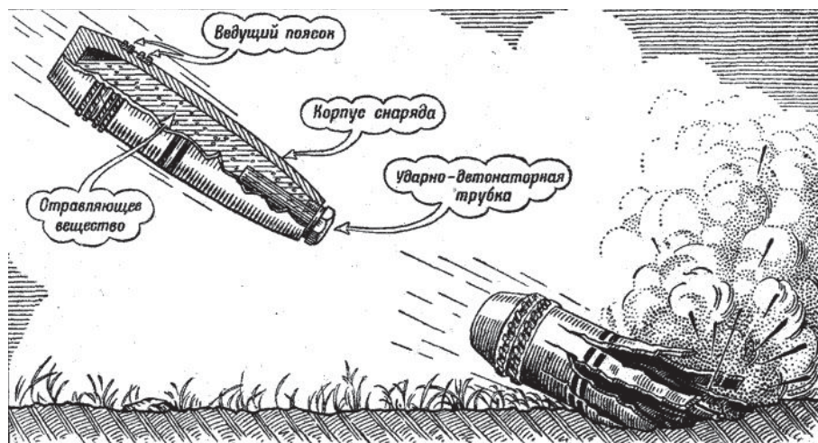
Принцип действия снаряда с отравляющим веществом
