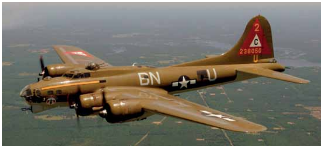
Boeing B-17 Flying Fortress (Б-17 «Летающая крепость») – первый серийный американский цельнометаллический тяжёлый четырёхмоторный бомбардировщик
