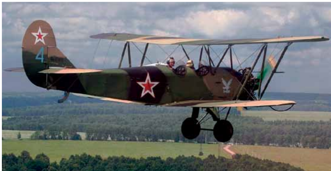
Советский самолёт У-2, он же По-2, – одномоторный биплан деревянной конструкции с неубирающимися шасси (санитарный вариант С-1, 2, 3)
