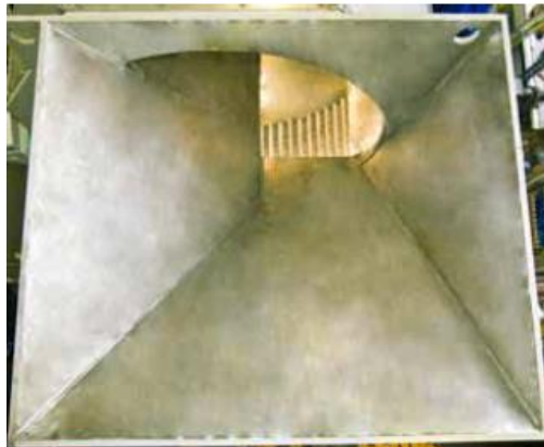
Ilustración 3-16: Tolva de entrada de remolacha. [9]
