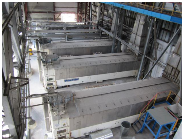
Ilustración 5-9: Prensas de pulpa I. [19]
