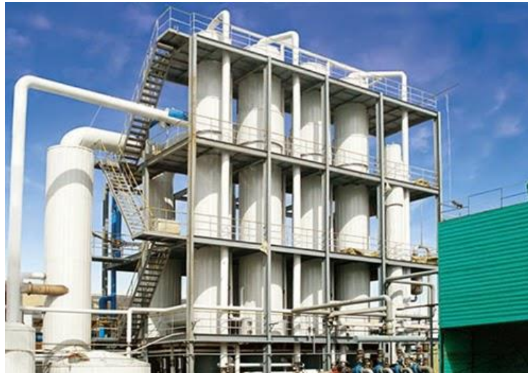
Ilustración 3-32: Evaporadores de efecto múltiple [12]
