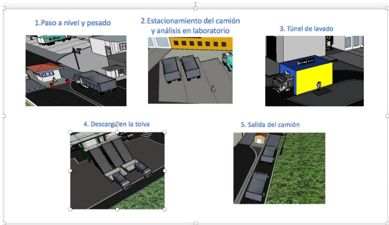
Ilustración 6-14: Proceso de descarga
