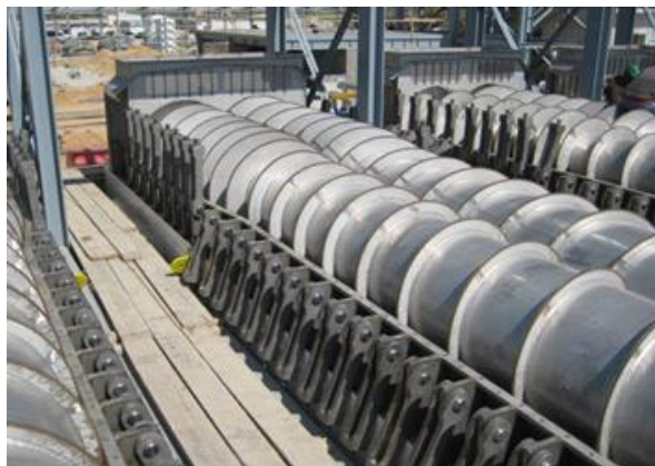
Ilustración 5-10: Prensas de pulpa II. [19]
