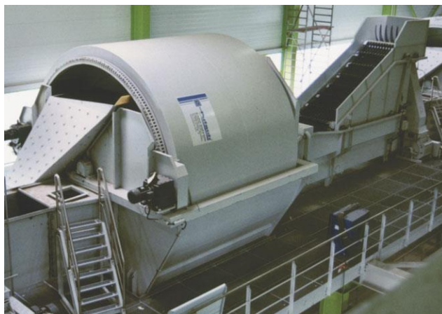
Ilustración3-7: Equipo separador de piedras. [5]
