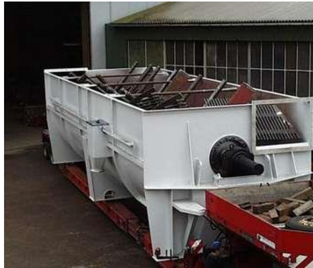
Ilustración 3-12: Imagen lavadora de brazos [7]
