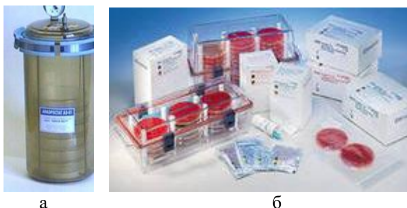
Рисунок 6.88 – Анаэростат (а), контейнеры для культивирования и газогенерирующие пакеты Gas Pack (б). Заимствовано из Интернет-ресурсов.
