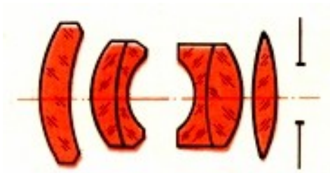
Оптическая схема объектива Гаусса для фотоаппаратов в XX веке
