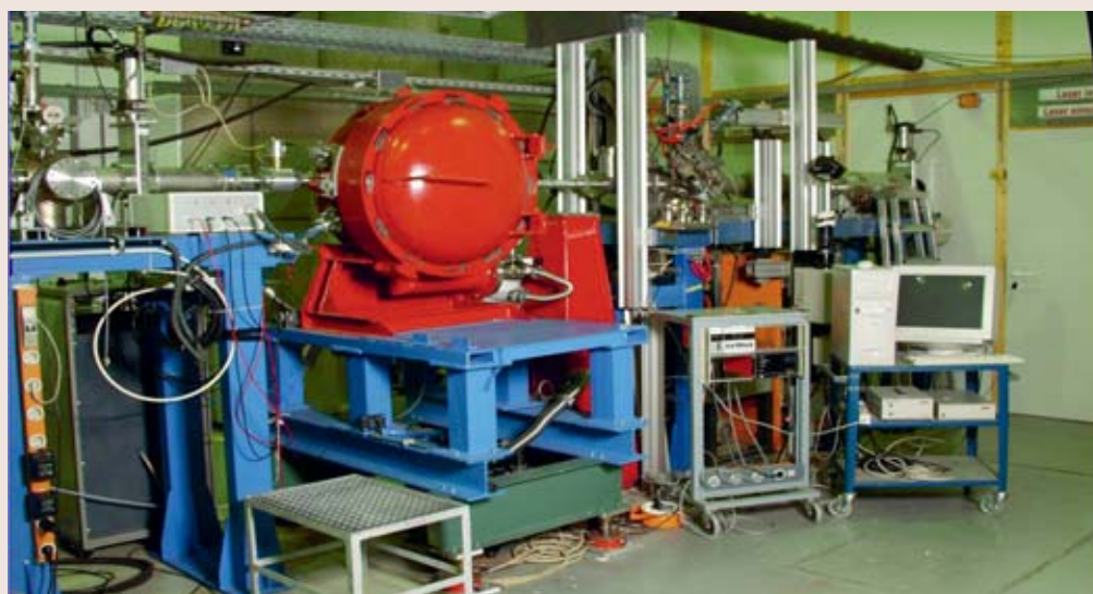
Ускоритель в GSI со взрывной камерой
