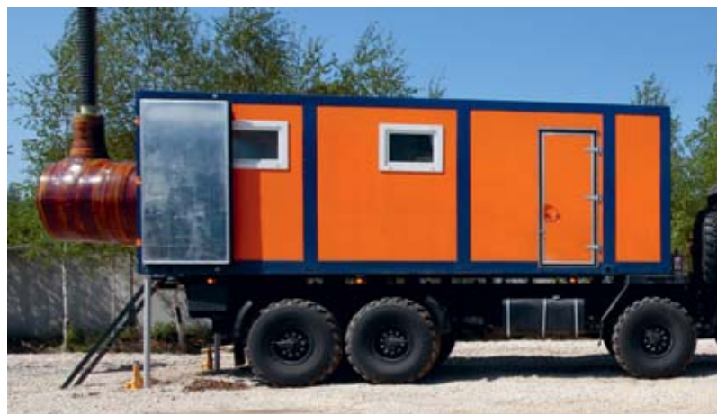
Имитатор токов молний на основе ВМГ
