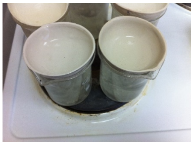
Рис. 8.41. Выпаривание на водяной бане
