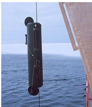
8.3. Опускание батометра в воду
