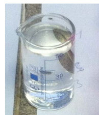
Рис. 8.35. Раствор сравнения (дистиллированная вода, в которую добавлен реактив Грисса)
