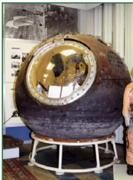
Реально летавший «гагаринский» СА КК «Восток» (ЗКА №3). Поролоновая обшивка заменена на новую
