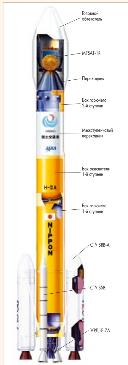
Характеристики отдельных систем ракеты H-IIA
