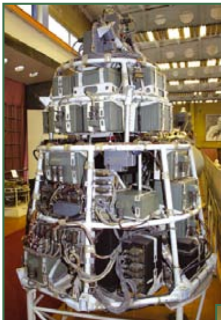
3-й советский искусственный спутник Земли. Отсек научной аппаратуры
