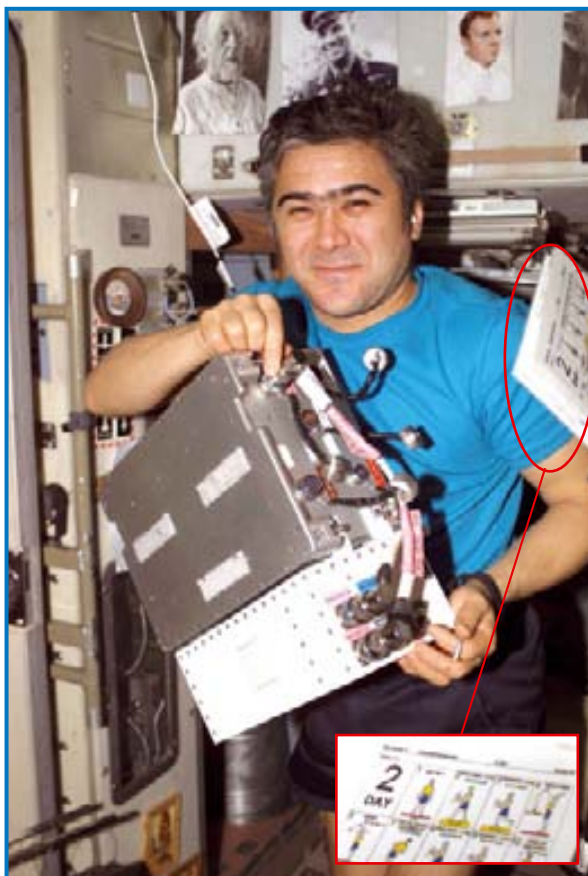
В руках Салижана – блоки управления и питания платформы TVIS. В кадр попала схема «утренней зарядки»
