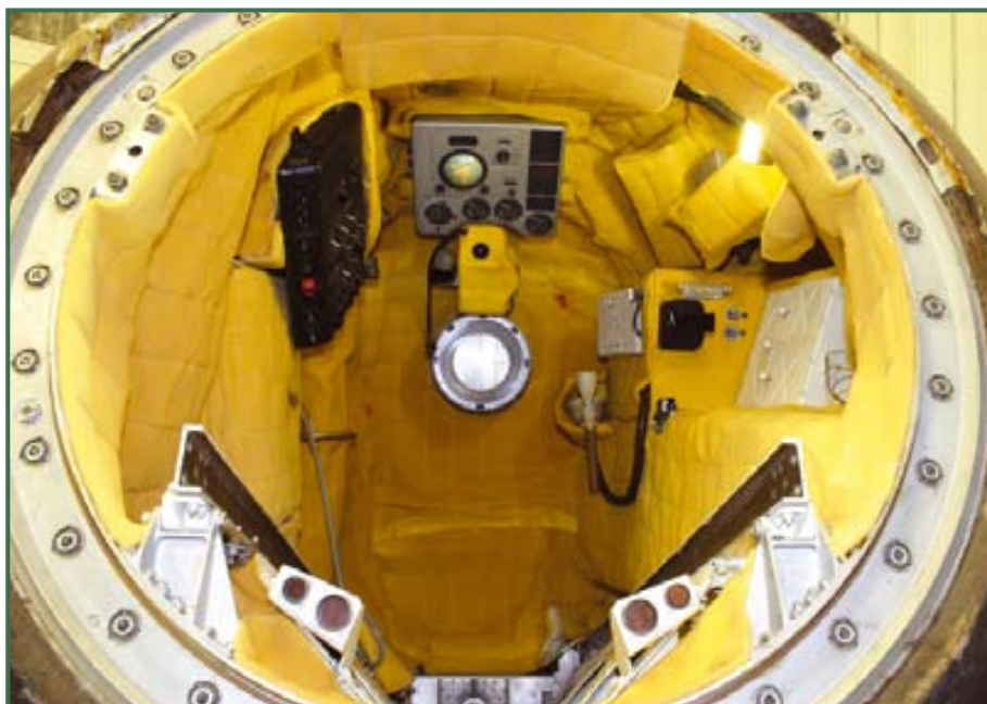
Реально летавший «гагаринский» СА КК «Восток» (ЗКА №3). Поролоновая обшивка заменена на новую
