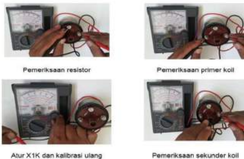
Gambar 1.77. Pemeriksaan koil pengapian menggunakan Ohm meter
