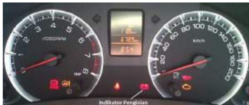
Gambar 3.61. Indikator lampu pengisian pada meter kombinasi
