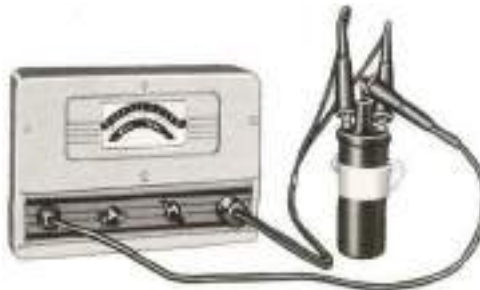
Gambar 1.78. Memeriksa koil menggunakan coil tester
