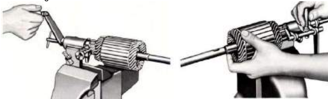
Memotong komutator bagian yang aus
