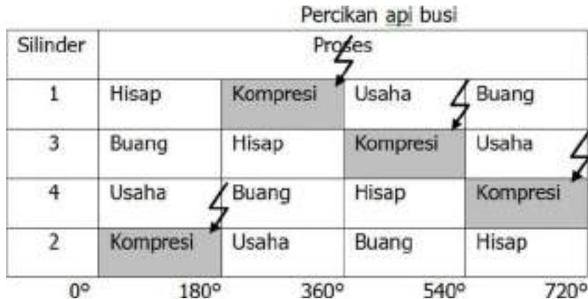
Gambar 1.3 Diagram urutan pembakaran motor 4 tak, 4 silinder
