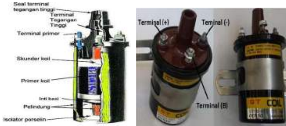
Gambar 1.9 Konstruksi Koil Pengapian
