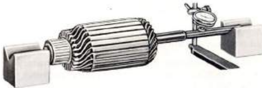
Gambar 2.66. Memeriksa kebengkokan poros armature
