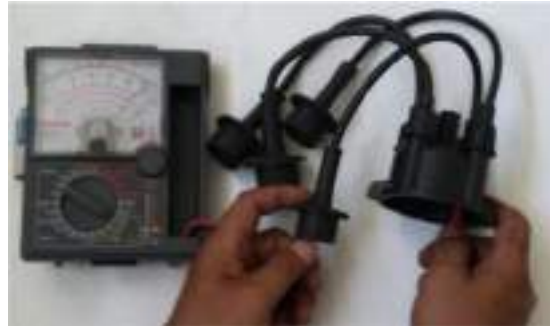
Gambar 1.58. Memeriksa kabel busi
