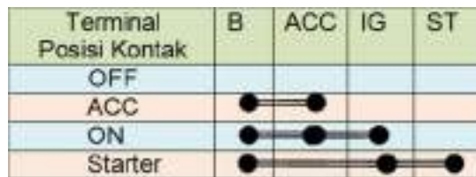
Gambar 1.76. Hubungan antar terminal kunci kontak
