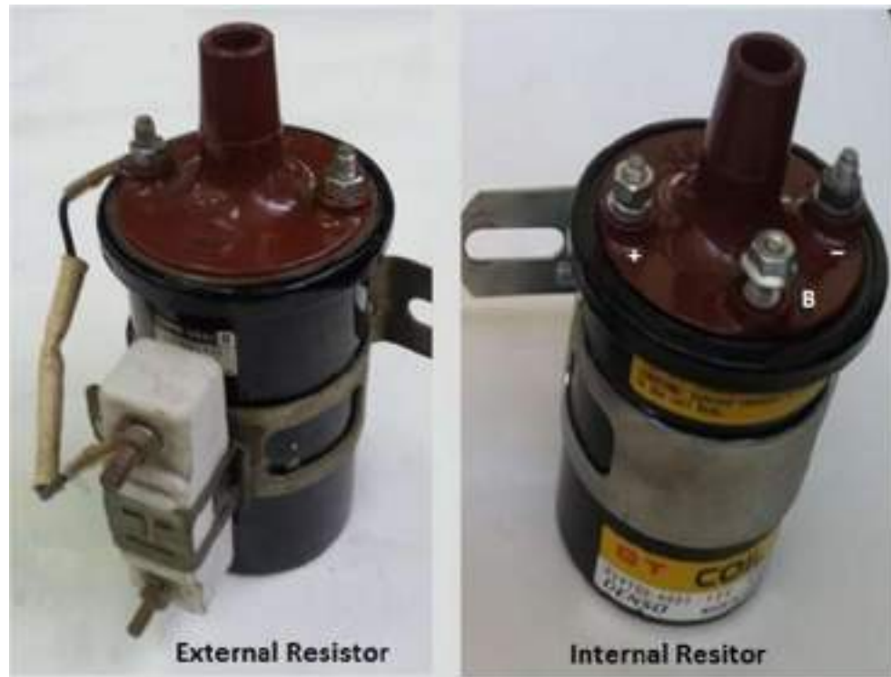
Gambar 1.12 Konstruksi koil pengapian dengan external resistor
