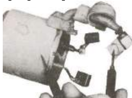
Pemeriksaan kebocoran ke bodi
