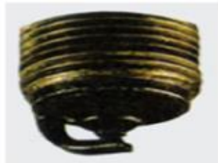
Gambar 35 : Kondisi Busi Berkerak Karbon
