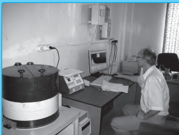
Доцент Е.И. Денисов проводит исследования на полупроводниковом гамма-спектрометре компании Ортекс, США.
