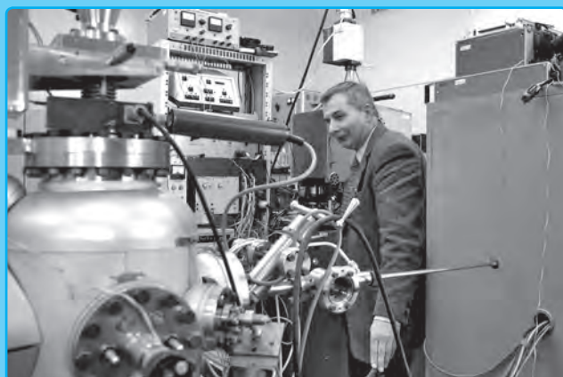
Доцент А.И. Слесарев проводит исследования на экзоэлектронном дефектоскопе
