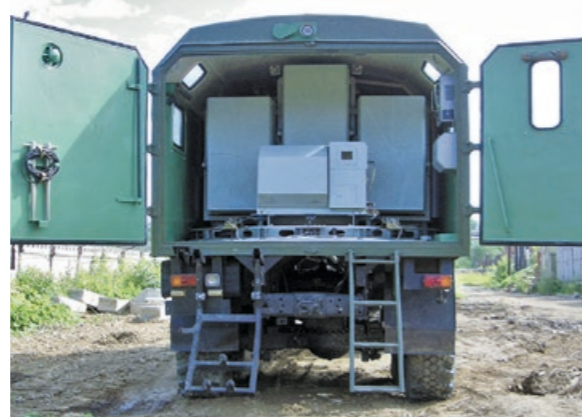
Детекторы комплекса «Соратник-01», установленные на поворотной платформе в КУНГЕ автомобиля КАМАЗ. Вверху видна одна из видеокамер (камера заднего борта).
