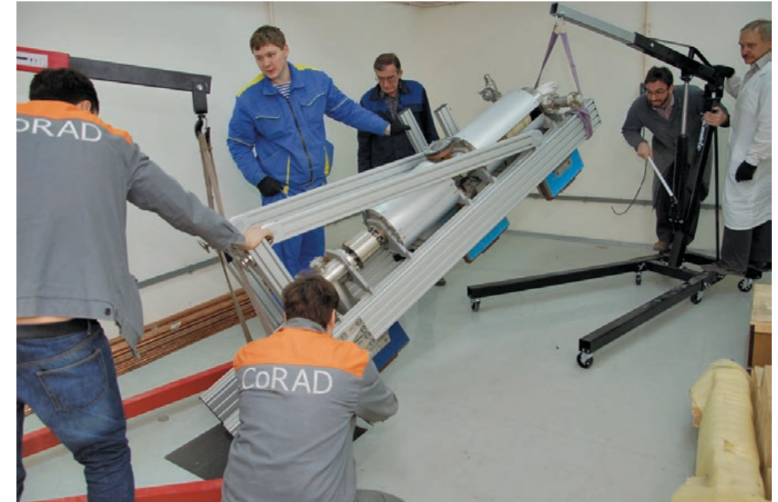
С.И. Бажуков, О.В. Рябухин и Ф.М. Клинов выполняют монтаж ускорительной колонны вместе с представителями производителя линейного ускорителя электронов НПП «Корад»
