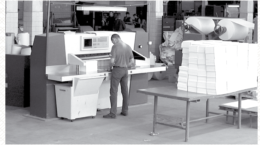
Резательная машина Wohlenberg-137 с электронной системой управления
