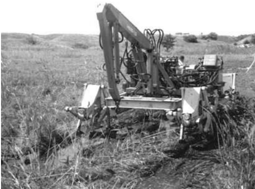
Рис. 16. Мобільний роботехнічний крокуючий комплекс для роботи на слабих і екологічно вразливих ґрунтах
