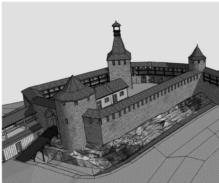
Рис. 2. Північна кам'яна частина замку, XII-XIII ст. Гіпотетична реконструкція. Автор 3D моделі – Бабюк Д.
