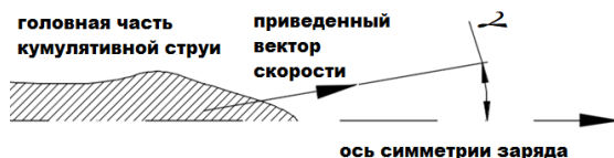
Рис. 1 – Схема оценки упорядоченности струеобразования
