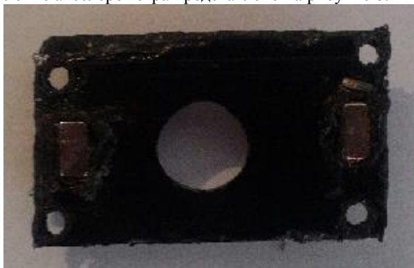
Рис.8 – Магнитное крепление акселерометра
