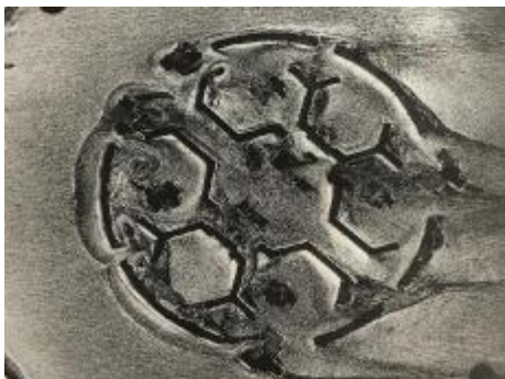
Визуализация структуры течения в приземном пограничном слое (второй микрорайон научного городка ВАСХНИЛ)
