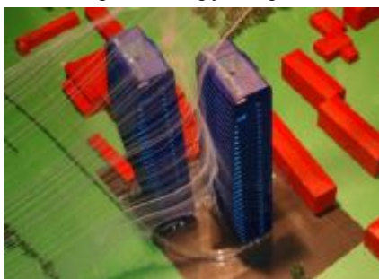
Испытания моделей высотных зданий в аэродинамической трубе
