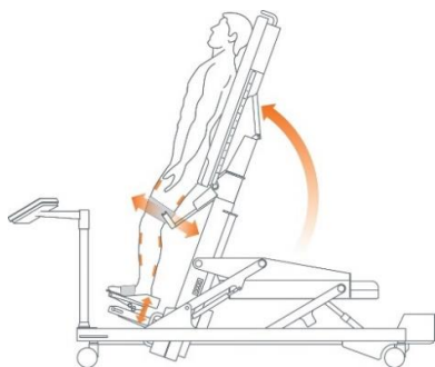
Рис. Механизм подъема системы вертикализации Erigo
