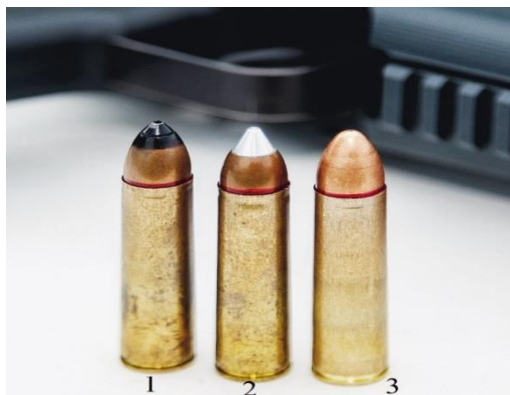
Рис.1. Пуля с термоупрочненным стальным сердечником (бронебойный) – 1, с легкой алюминиевой пулей с антирикошетным эффектом (экспансивный) – 2, с тяжелой свинцовой пулей с дозвуковой скоростью (бесшумный) – 3.
