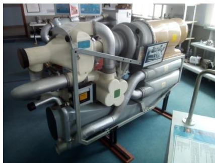
Рис. 1. Основной блок охлаждения СКВ ЛА
