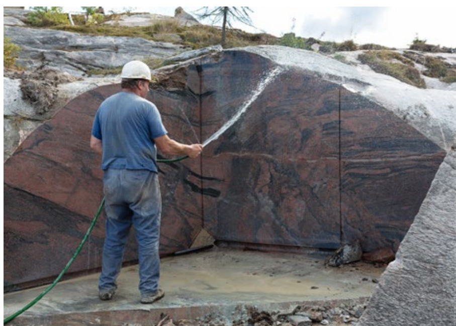
Результат, резки камня с применением алмазных канатов.
