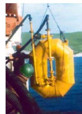
Морские испытания нового гидроподъемного устройства.
