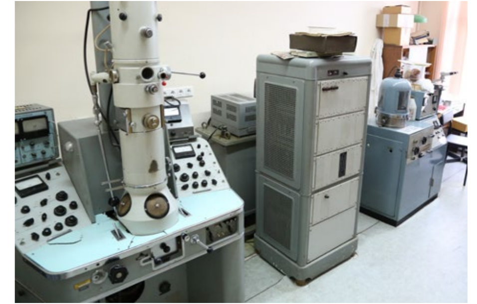
Лаборатория физических методов исследования горных пород и руд МГРИ-РГГРУ (электронный универсальный микроскоп ЭММА-2).
