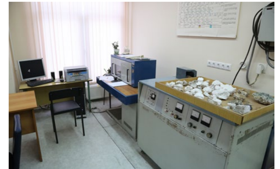
В лаборатории физических методов исследования руд и минералов (рентгенофлуоресцентный анализатор АРФ-6).
