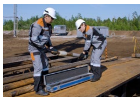
Схема размещения ЗТС и опытный образец оборудования с гидравлическим каналом передачи телеметрических данных контроля процесса бурения.
