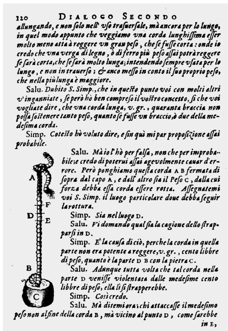
Рис. 2.3. Доведення Галілея, що довга мотузка не слабкіша за коротку
