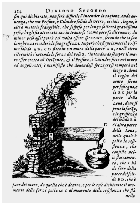
Рис. 2.4. Частина з міркувань Галілея про опір розриву консольної балки
