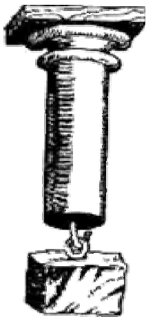
Рис. 2.2. Ілюстрація Галілея до випробування на розтяг
