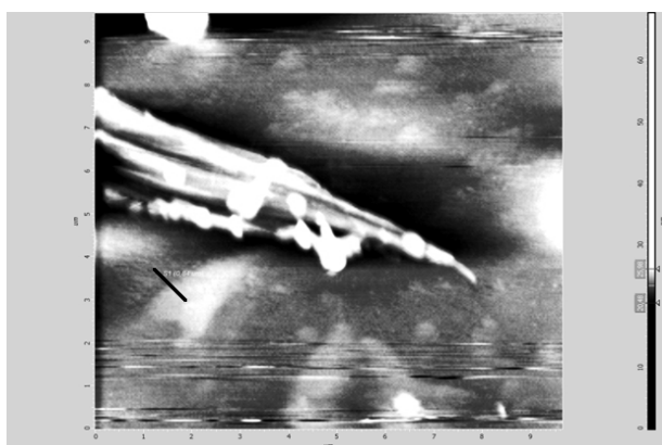
Рис. 2. Графеновые пленки, полученные электростатическим осаждением пиролитического графита на подложку Si/SiO 2
