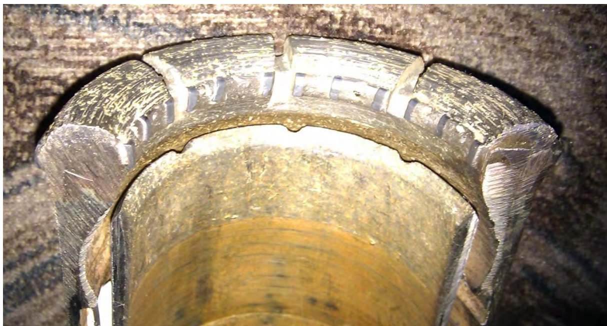
Рис. 2. Доработанный буровой инструмент
