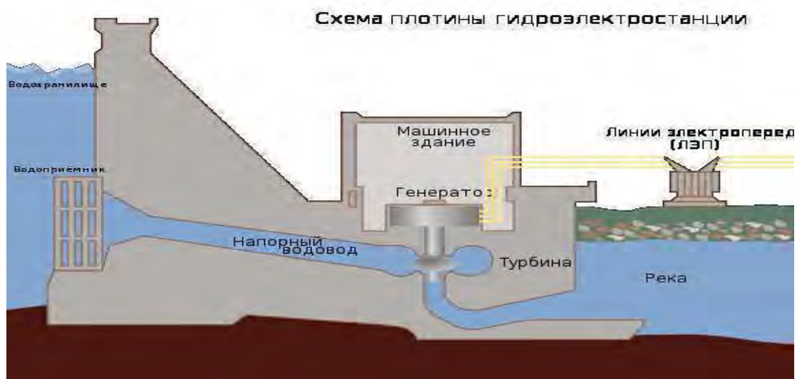
Рис. 5. Принцип работы ГЭС, схема плотины ГЭС
