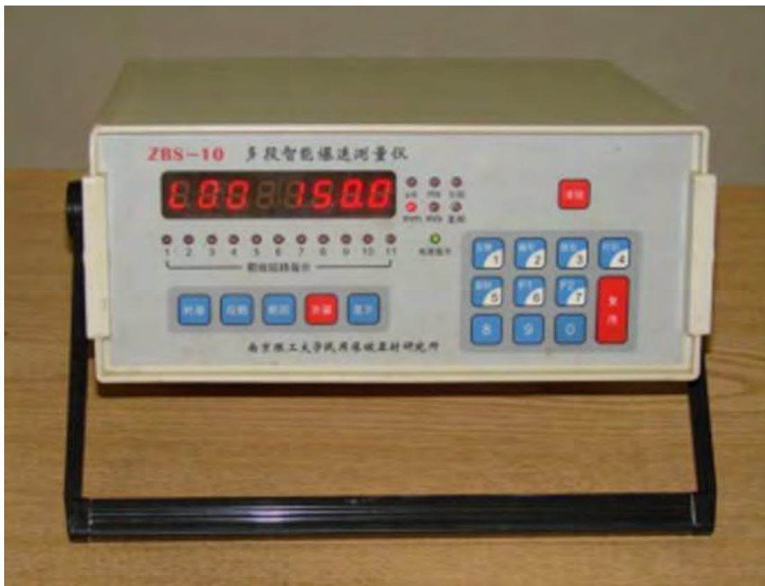
Рис. 2. Многоинтервальный измеритель скорости детонации ZBS-10
