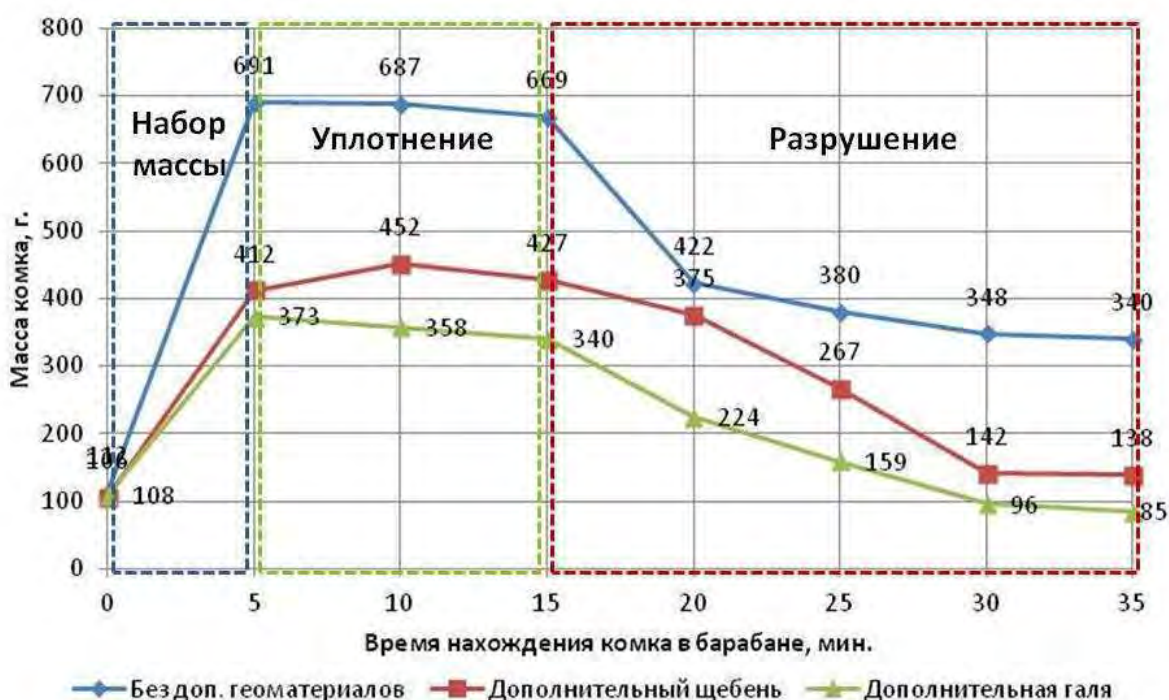
Рис. 1. Динамика разрушения особоплотных глинистых агрегатов в промывочных аппаратах барабанного типа при введении в процесс дезинтеграции дополнительных геоматериалов
