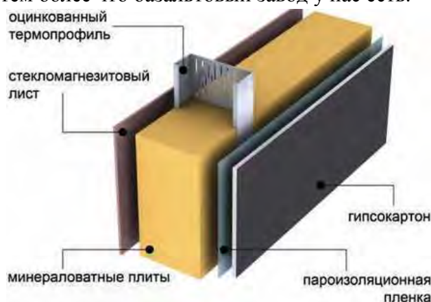
Рис. 1. Разрез термопанели
