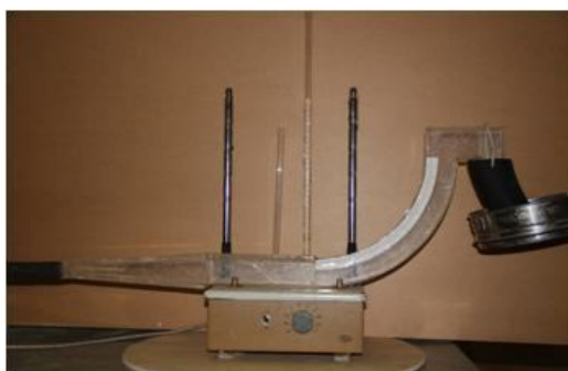
Рис. 3. Лабораторная модель кривой трубы
