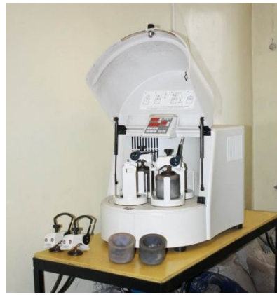
Рис. 1. Планетарная мельница Pulverisette 5
