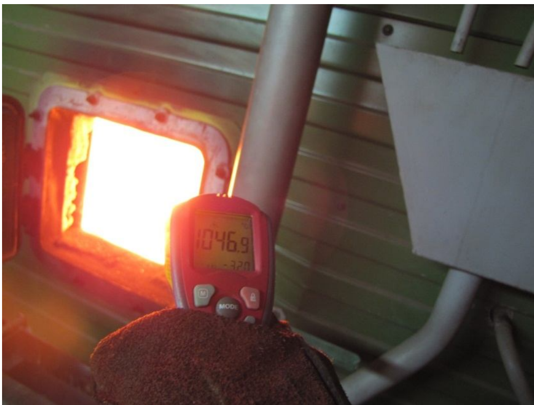
Рис. 1. Горение в топке и показание пирометра (температура слоя)
