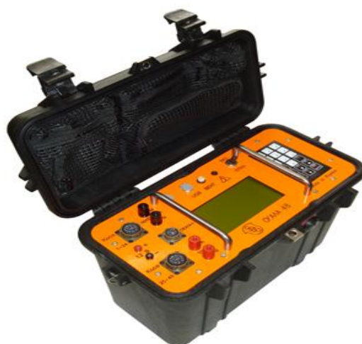
Рис. 2. Аппаратура электротомографии «Скала-48»
