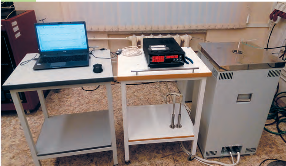
Государственный вторичный эталон единицы температуры в диапазоне от минус 189,3442 °С до 1768,2 °С (ГВЭТ 34-29-2009) ФГУП "ВНИИМ им. Д.И. Менделеева" 2016 г.
