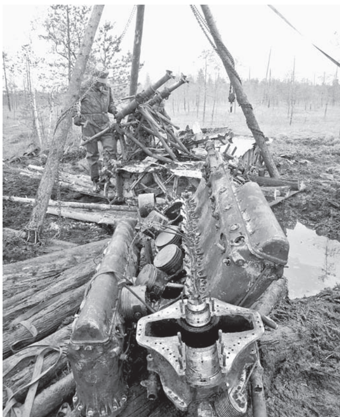
Уже удалось снять одну головку блока и отстыковать редуктор.
