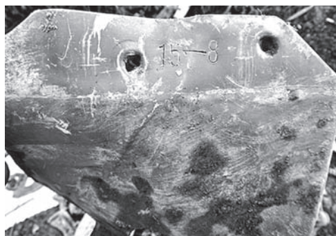
Выбитый дублированный номер самолета Пе-2.
