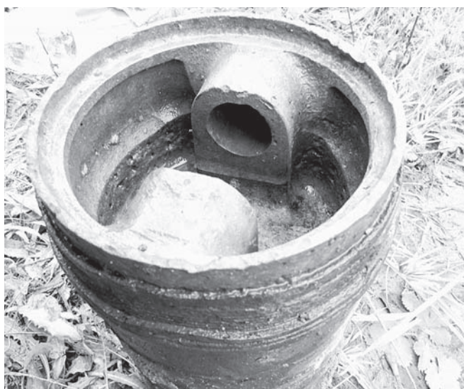
Поршень мотора М-105 № к 23-1067, найденный на месте падения самолета.
