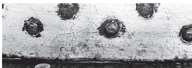
Технологические номера на лонжеронах крыла, указывающие на предполагаемую серию самолета.
