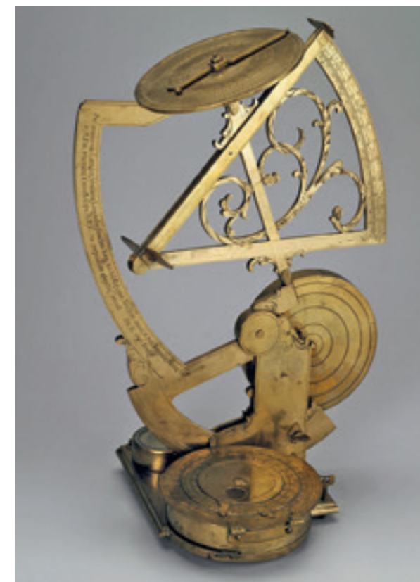
Универсальный мореходный астронавигационный инструмент, включает в себя часы солнечные универсальные механические. Италия, Венеция 1697 год. Предмет из Кабинета Петра Великого, Государственный Эрмитаж
