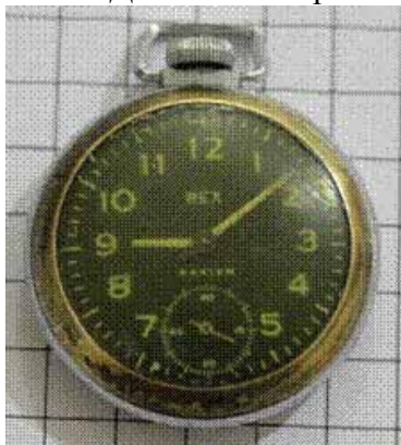
Рис. 18. Швейцарские часы фирмы «CREATION WATCH Co» При непосредственном контакте с циферблатом часов индикатор радиоактивности РД1503 показывает 3,70 мкЗв/ч.
