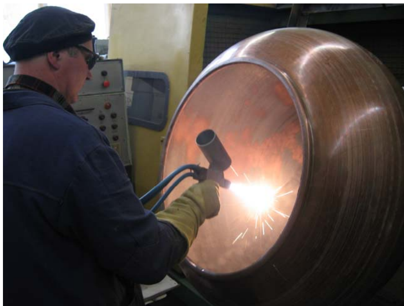
Восстановление оборудования газопламенным напылением
