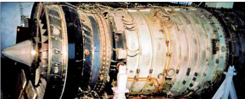
Опытный ТРДДФ НК-6 с форсажной камерой во внешнем контуре
