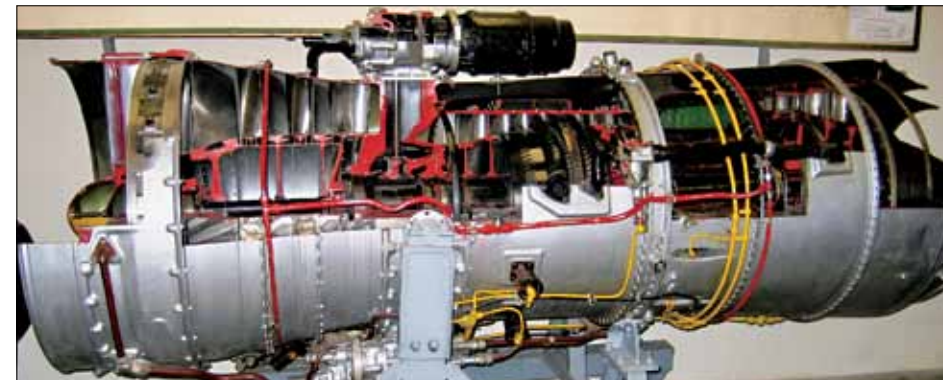
Первый отечественный серийный двухроторный ТРДД Д-20П
