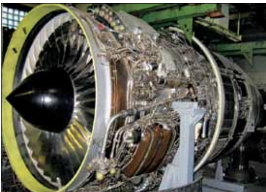
ТРДД ПС 90А — двигатель пассажирских самолётов Ту-204, Ил-96-300
