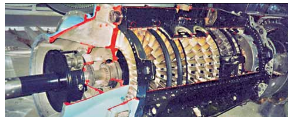
Экспериментальный ТВД Jumo-022
