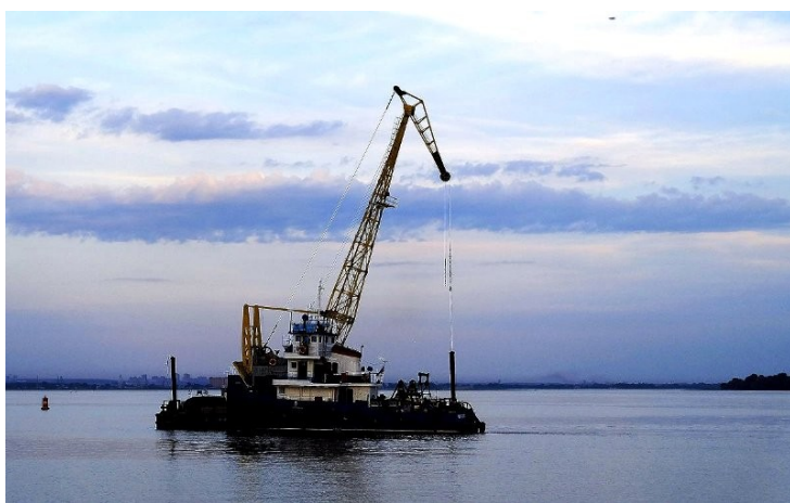
Плавкран грузоподъемностью 5 тонн. Проект Р-99. Построено 3 единицы;
