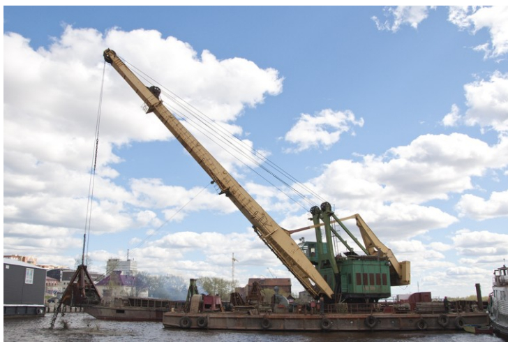
Плавкран грузоподъемностью 16 тонн Проект Р-108. Построено 12 единиц;
