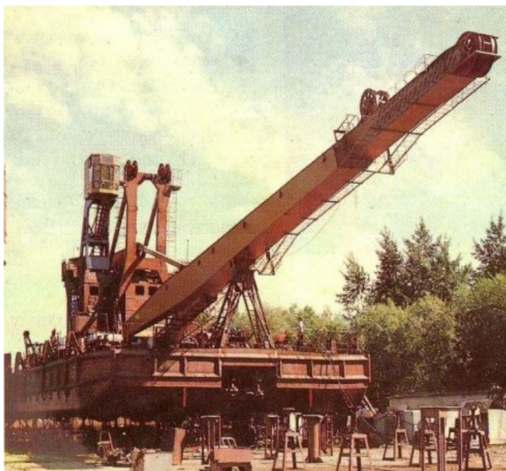
Плавкран грузоподъемностью 27 тонн. Проект 721. Построено 3 единицы.
