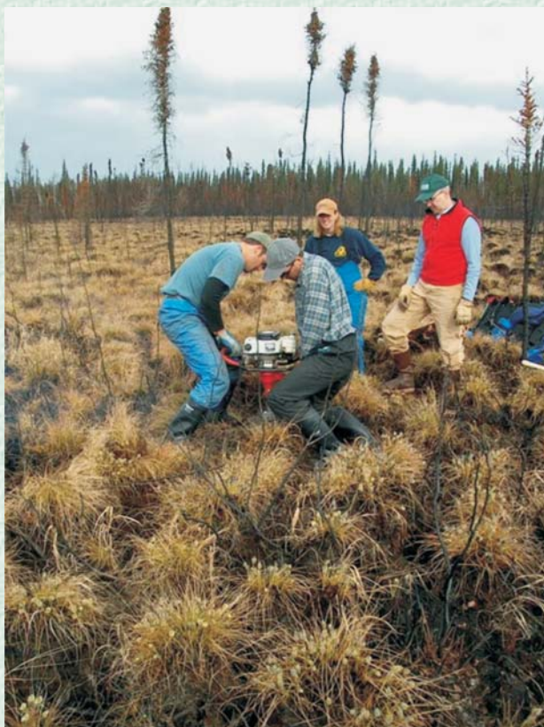
Бурение термометрических скважин по проекту PYRN – TSP (2006 г.).
