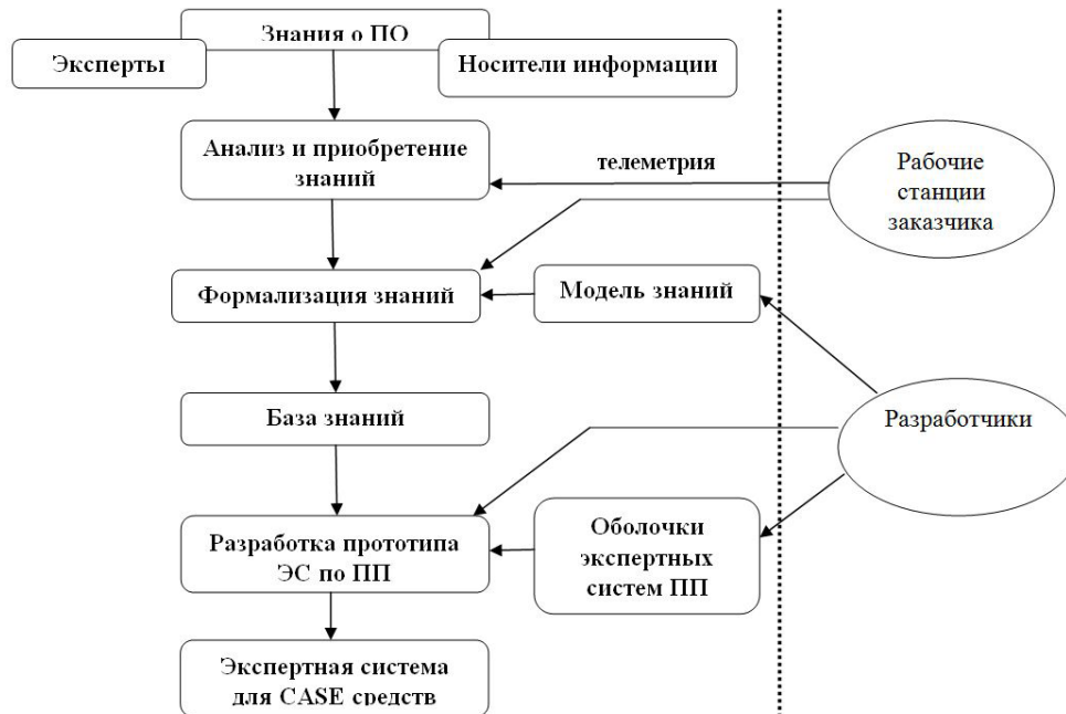
Рисунок 6 – Соотношение между разработчиками и заказчиками в экспертной системе
