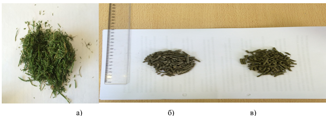
Рисунок 3 – Образцы отходов (исходный материал и продукты переработки) а) скошенная газонная трава; б) органоминеральные гранулы; в) зернотравяные гранулы
