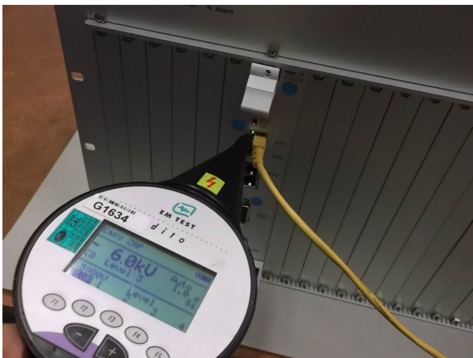
Prüfaufbau für direkte Entladung Test set-up for direct discharge
