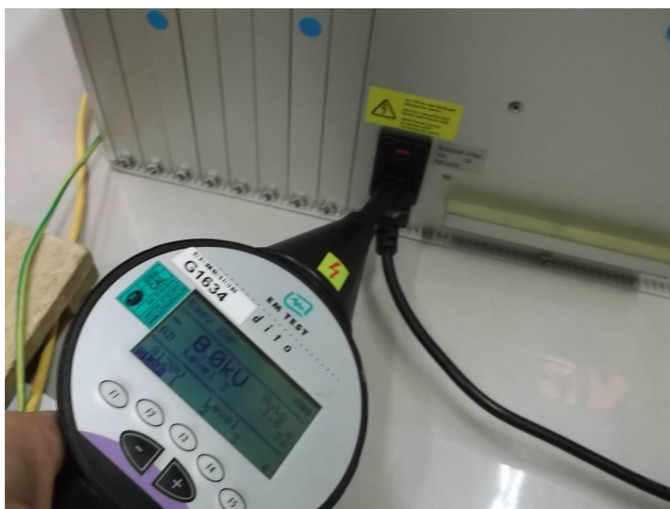
Prüfaufbau für Luftentladung Test set-up for air discharge
